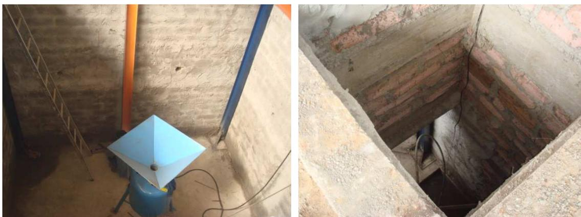
**Figura 40 - Moega para acondicionamento de areia base.**
