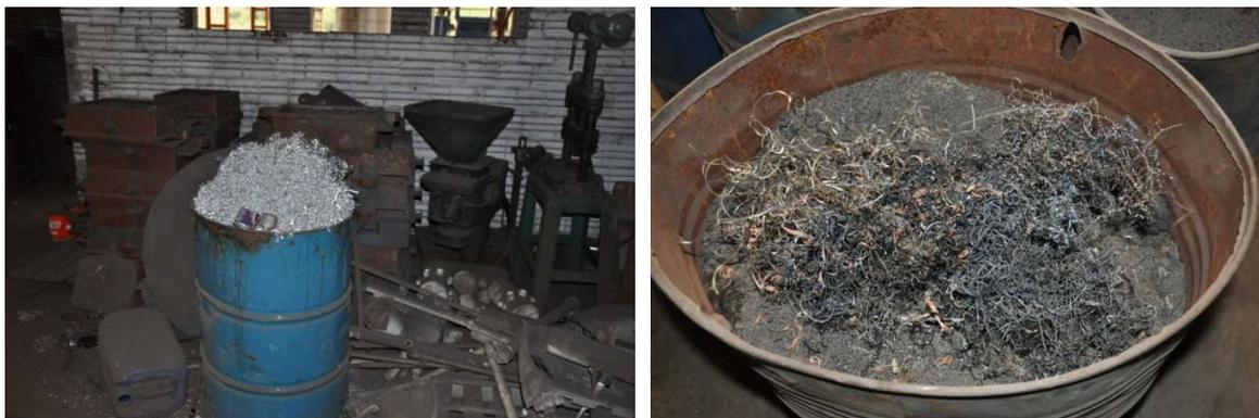
**Figura 38 - Cavacos de alumínio e ferro.**
