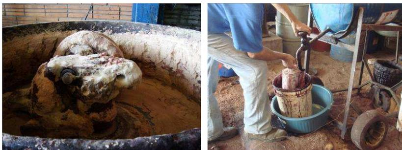
**Figura 28 - Preparação da Areia Fenólica com misturador Simpson.**
