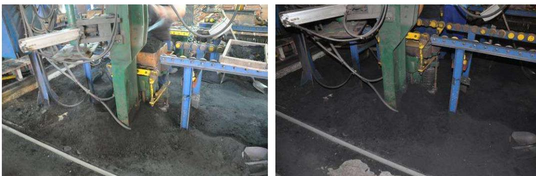
**Figura 30 - Areia verde no chão ao redor da máquina de moldagem.**
