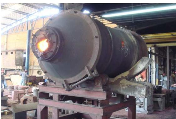
**Figura 26 - Forno Rotativo a Óleo.**
