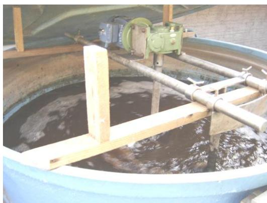
Figura 9. Misturador de superfície no TE.
