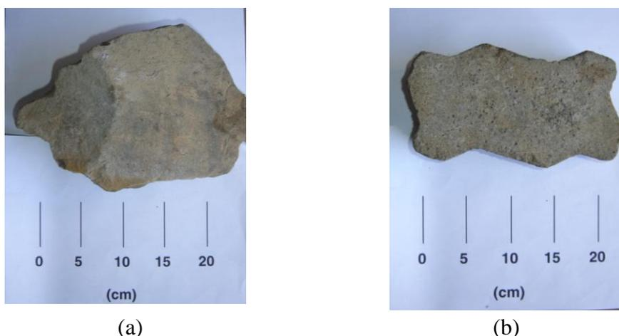
Figura 10. Meios suportes usado nos filtros anaeróbios: (a) rachão, (b) blocos de concreto.
