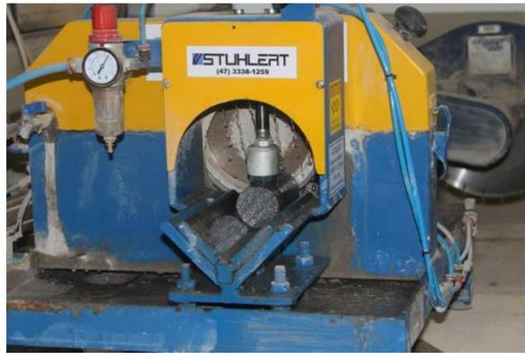
**Figura 34 – Corpo-de-prova sendo retificado.**
