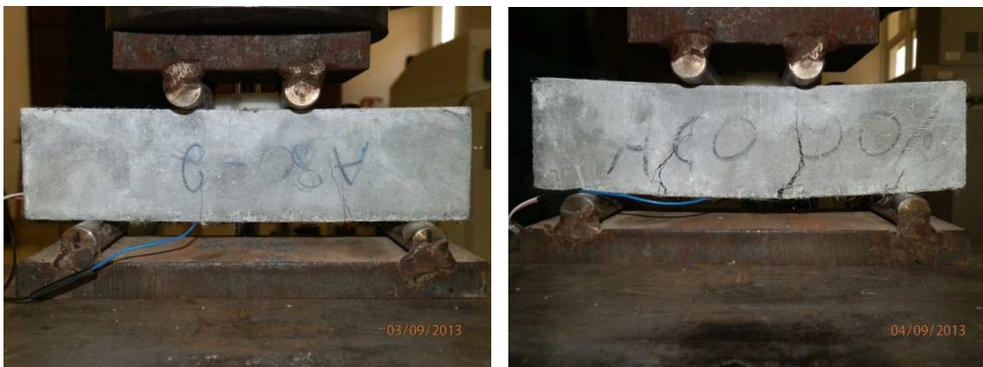
**Figura 51 – Fissuras fora do terço médio dos corpos-de-prova.**
