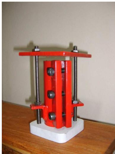
**Figura 33 – Fôrma cilíndrica utilizadas na pesquisa.**
