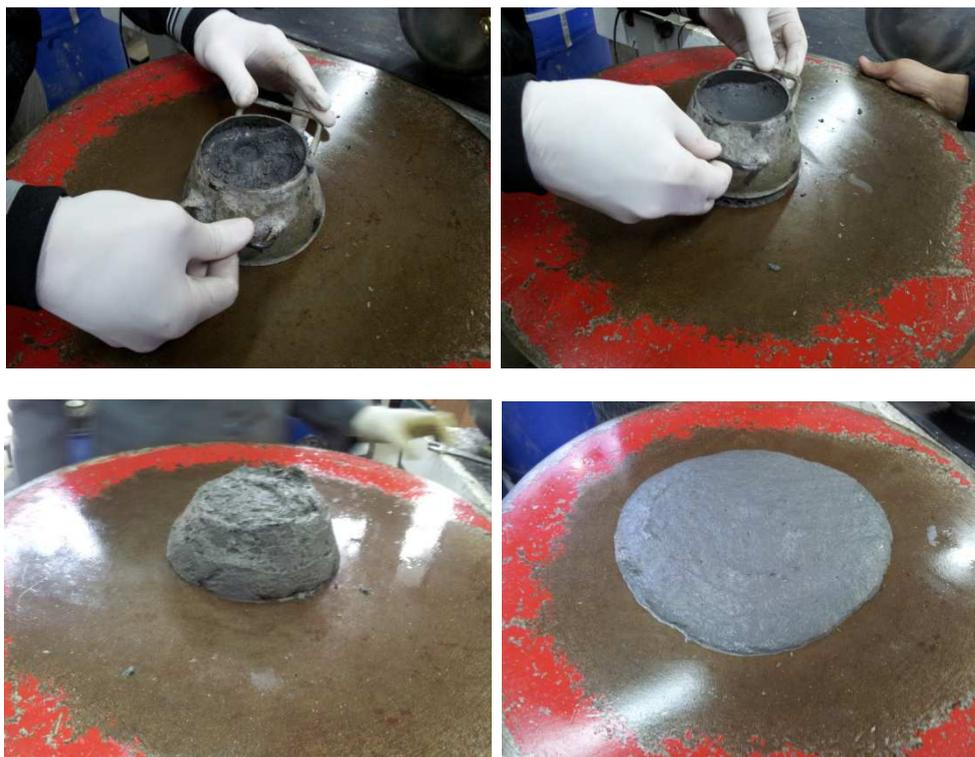
**Figura 31 – Ensaio de abatimento nas misturas de CPR.**
