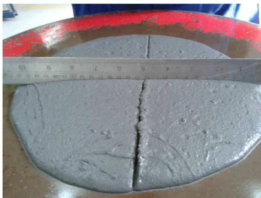
**Figura 46 – Trabalhabilidade do CPR em ensaio na mesa de consistência.**
