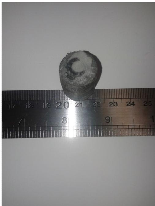
**Figura 63 – Corpo-de-prova utilizado para ensaio da microtomografia 3D.**
