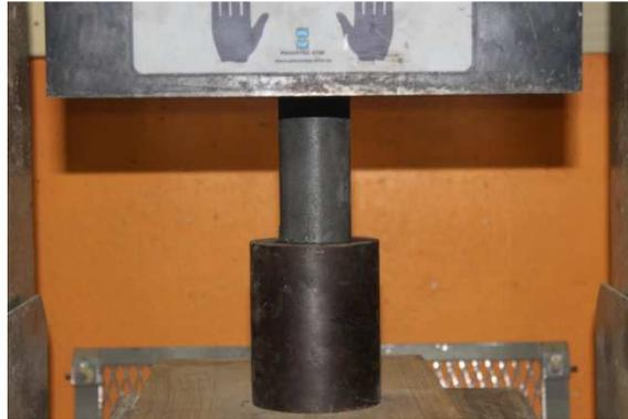
**Figura 32 – Corpo-de-prova em ensaio de compressão axial.**
