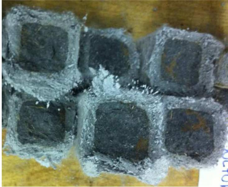
**Figura 60 – Visualização interna dos corpos-de-prova submetidos a ataque químico em ácido sulfúrico.**
