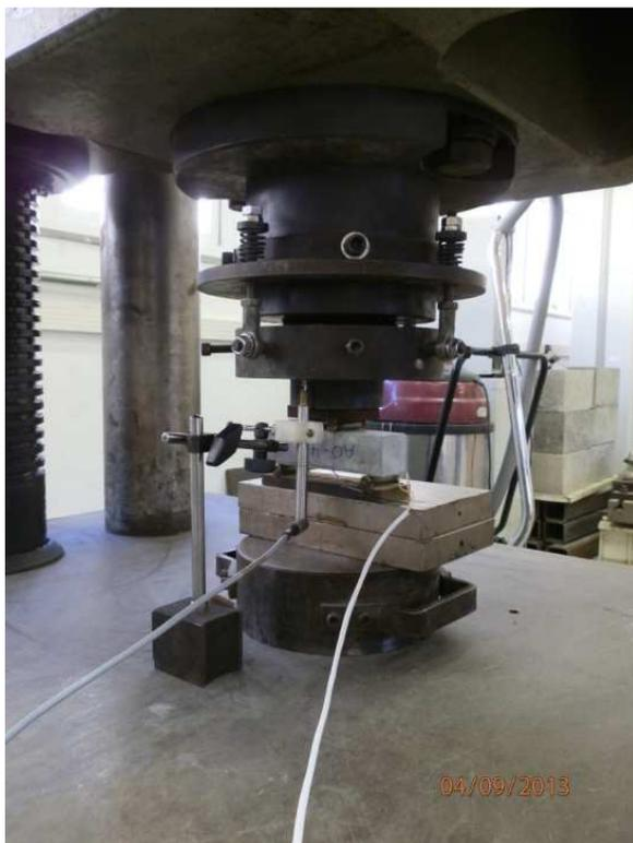
**Figura 36 – Instrumentação das amostras ensaiadas a flexão.**
