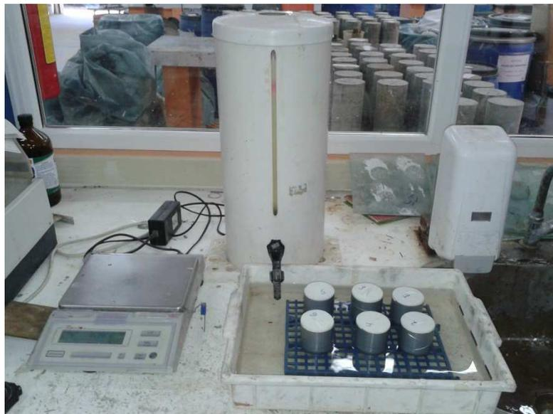
**Figura 61 – Ensaio de absorção capilar.**
