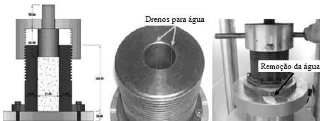
**Figura 13 – Forma desenvolvida para aplicação de pressão confinante em concreto**
