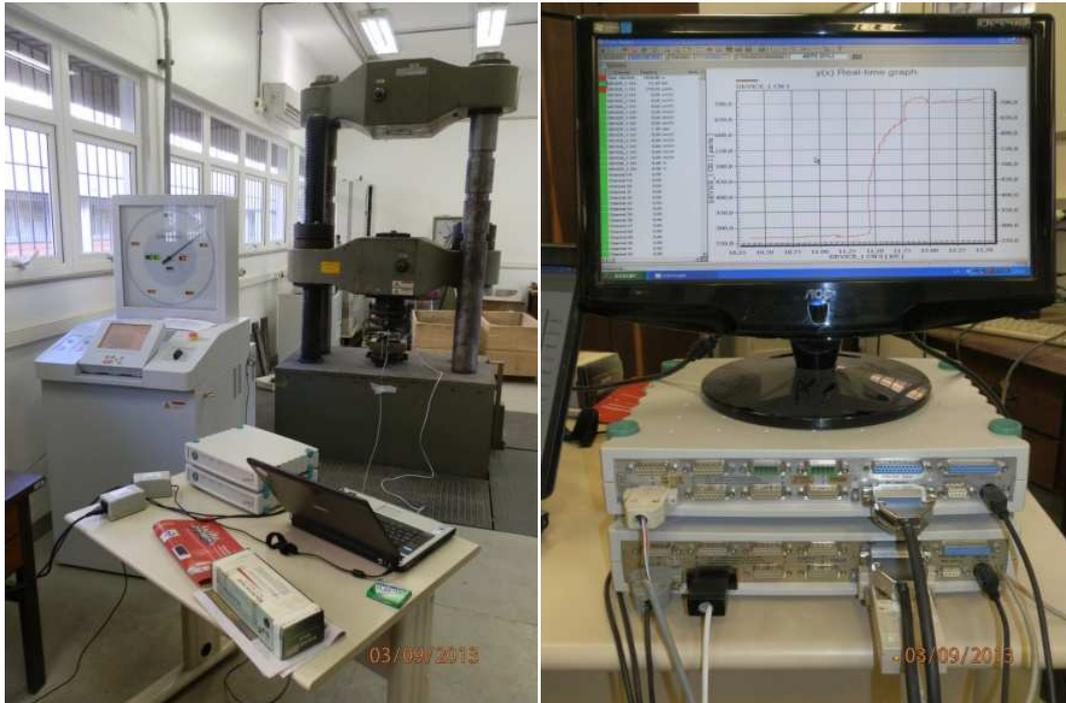
**Figura 37 – Equipamentos utilizados para aquisição de dados.**
