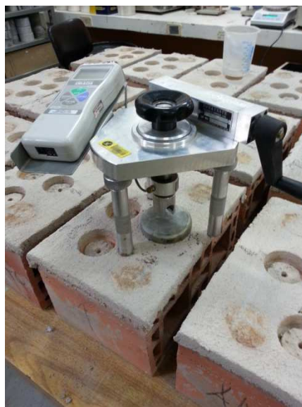
Figura 34 – Equipamento utilizado para a aplicação de carga de tração nos revestimentos
