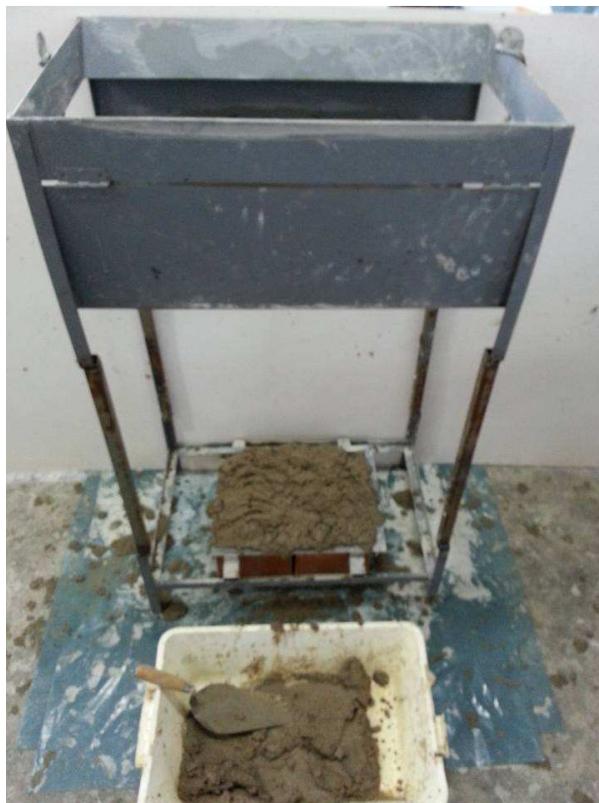
Figura 12 – Caixa de queda utilizada para aplicação das argamassas
