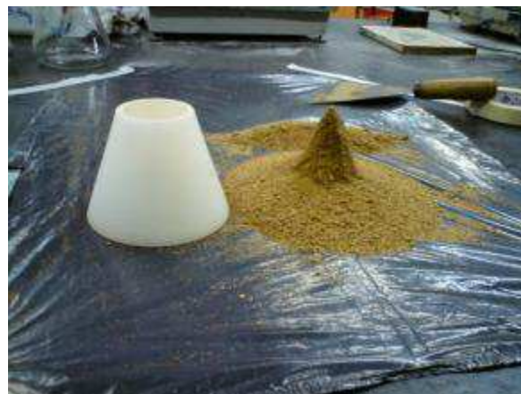
Figura 9 – Procedimento do ensaio de massa específica do agregado miúdo (AN)
