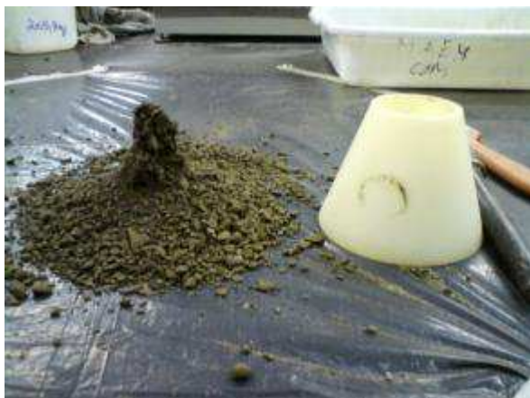
Figura 8 – Procedimento do ensaio de massa específica do agregado miúdo (AB)
