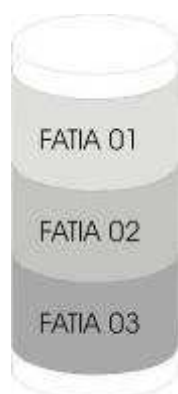
Figura 16. Subdivisão do corpo-de-prova para o ensaio de absorção por capilaridade.
