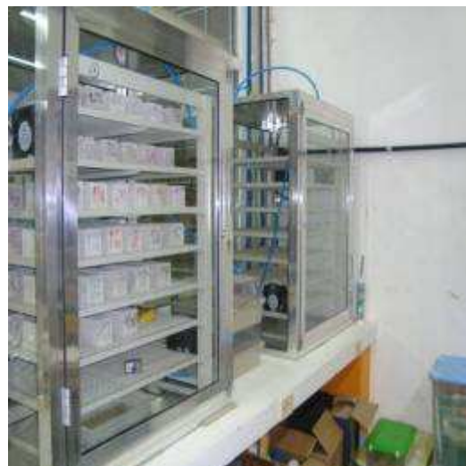
Figura 29. Disposição dos corpos-de-prova na câmara de carbonatação.
