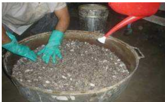
Figura 25. Execução da pré-molhagem.
