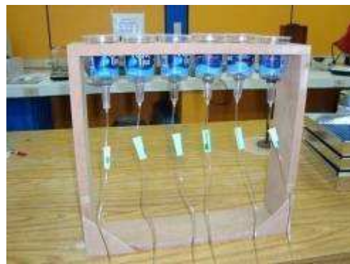
Figura 20. Suporte para o abastecimento contínuo de água para o ensaio de absorção por capilaridade.
