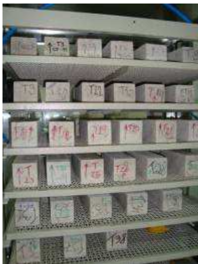
Figura 28. Disposição dos corpos-de-prova na câmara de carbonatação.
