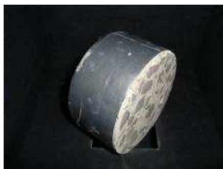
Figura 17. Preparo da amostra para o ensaio de absorção por capilaridade.
