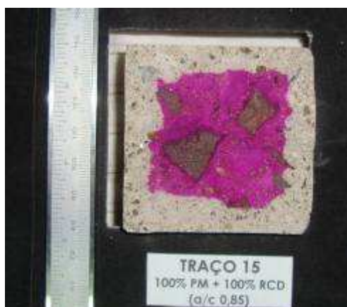
Figura 30. Amostra carbonatada com referência de escala.
