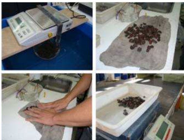
Figura 13. Ensaio de absorção por imersão dos ARC e AN.
