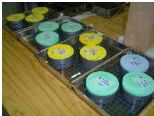
Figura 19. Recipiente para o ensaio de absorção por capilaridade.
