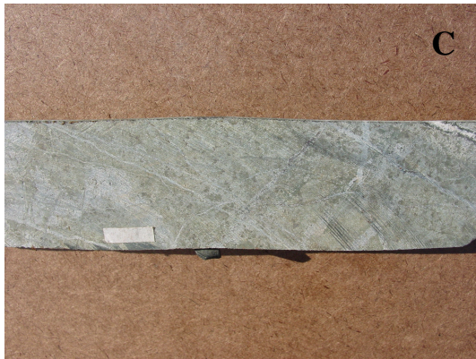
Figura 11- A- Aspecto macroscópico do gabro com matriz intensamente biotitizada. B- Aspecto macroscópico do gabro com textura subofítica, composto de anfibólios cálcicos, plagioclásio e biotita verde. C- Aspecto macroscópico do gabro com vênulas de quartzo e albita cortando a matriz parcialmente biotitizada. D- Aspecto macroscópico do gabro com textura ofítica reliquiar, composto de anfibólios cálcicos, plagioclásio e biotita, cortado por veios de quartzo, biotita verde e albita. As escalas medem 2cm.
