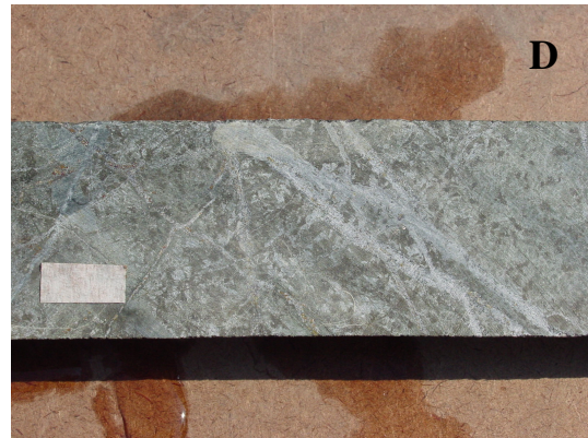
Figura 11- A- Aspecto macroscópico do gabro com matriz intensamente biotitizada. B- Aspecto macroscópico do gabro com textura subofítica, composto de anfibólios cálcicos, plagioclásio e biotita verde. C- Aspecto macroscópico do gabro com vênulas de quartzo e albita cortando a matriz parcialmente biotitizada. D- Aspecto macroscópico do gabro com textura ofítica reliquiar, composto de anfibólios cálcicos, plagioclásio e biotita, cortado por veios de quartzo, biotita verde e albita. As escalas medem 2cm.
