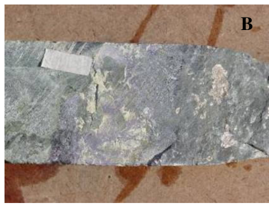
Figura 6- A - Veios de biotita verde e quartzo cortados por vênulas de quartzo, B - Veio de biotita verde, fluorita roxa e calcopirita. A escala (fita) mede 2cm.
