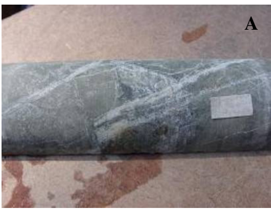
Figura 6- A - Veios de biotita verde e quartzo cortados por vênulas de quartzo, B - Veio de biotita verde, fluorita roxa e calcopirita. A escala (fita) mede 2cm.
