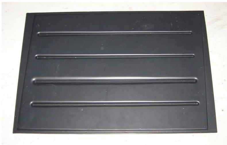
Figura 5.9 - Protótipo de um coletor solar plano polimérico
