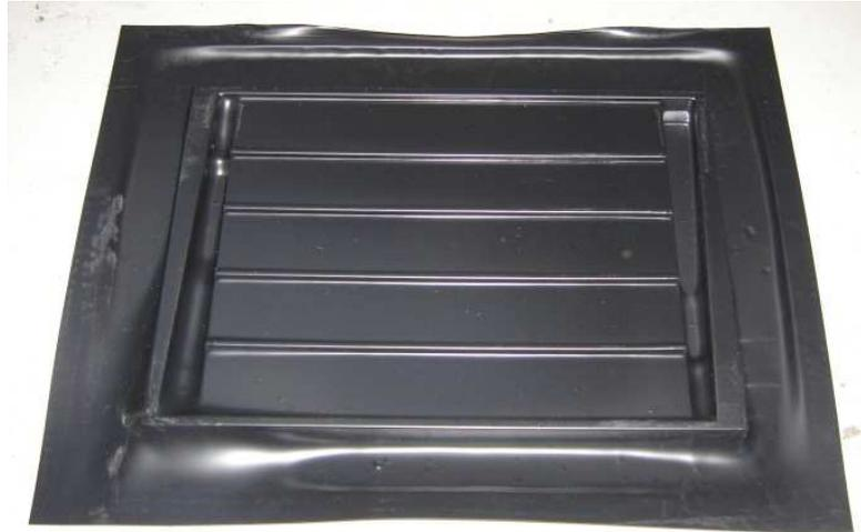
Figura 5.7 - Coletor solar polimérico extraído da matriz.
