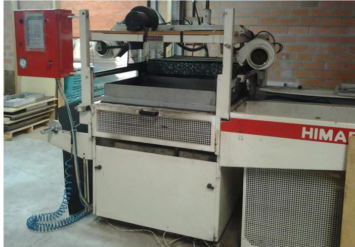
Figura 5.5 - Máquina de termoformagem
