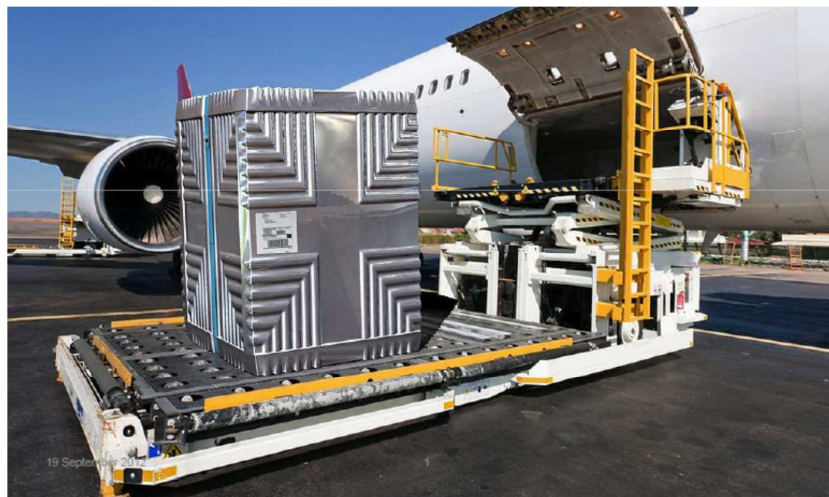
Figura 2.10 – Exemplo de embalagem utilizando tecnologia PCM.
