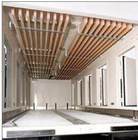
Figura 2.9 – Exemplo de compartimento refrigerado de caminhão dotado de placas de PCM.
