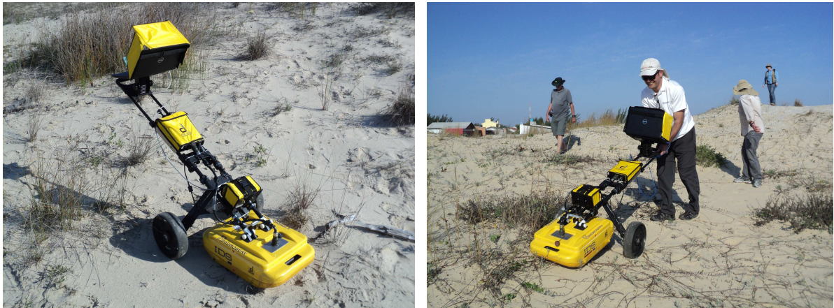
FIGURA 20 - GPR com antenas de 250 e 700 Mhz e aquisição dos perfis no sítio. Fonte: Acervo do Autor.
