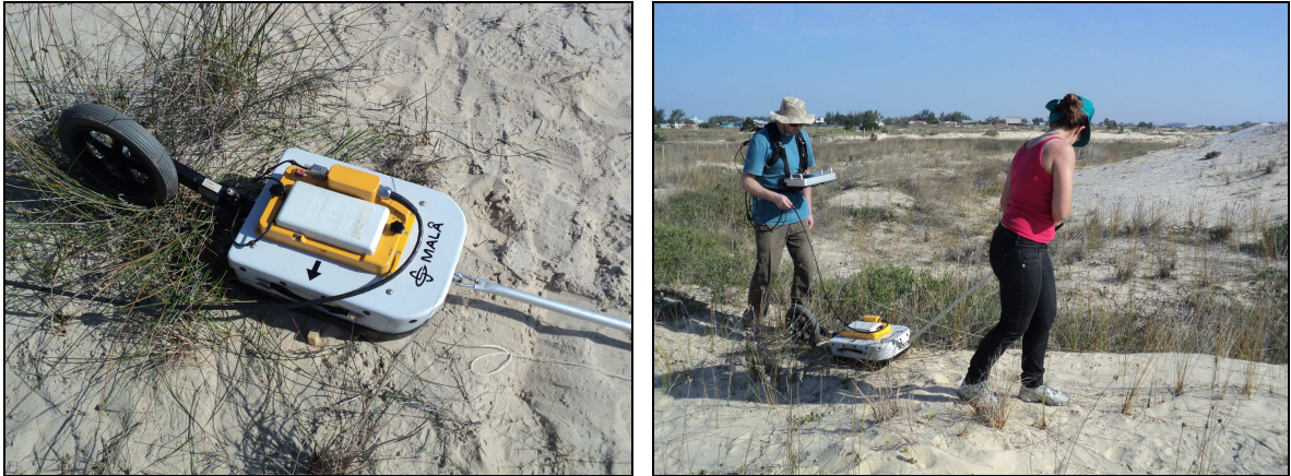
FIGURA 19 – GPR com antena de 500 Mhz e aquisição dos perfis no sítio. Fonte: Acervo do Autor.
