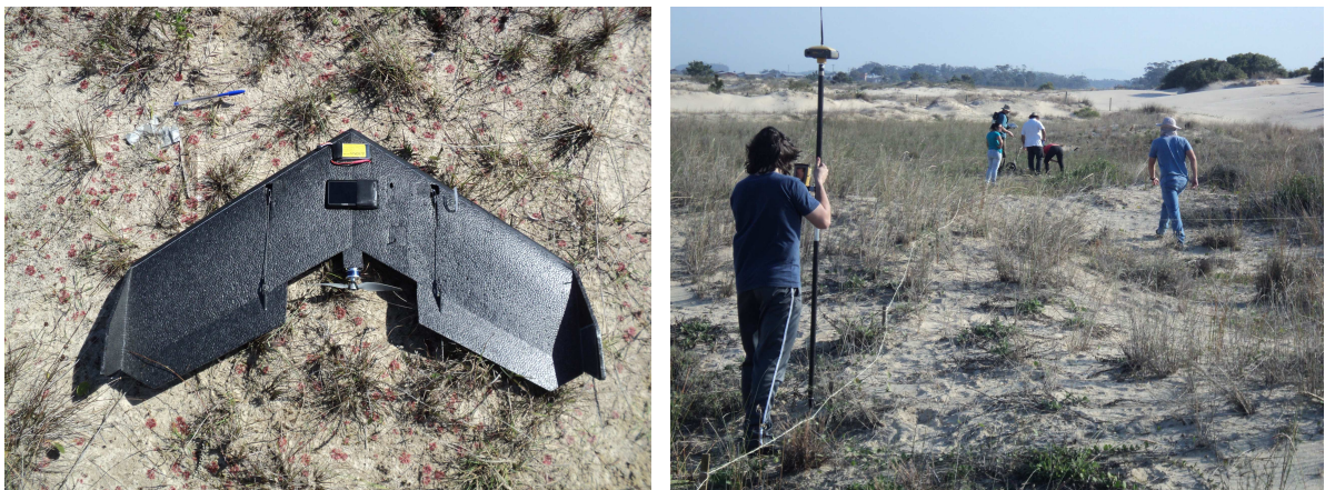
FIGURA 21 – VANT e GPS utilizados para o levantamento topográfico do sítio. Fonte: Acervo do Autor.
