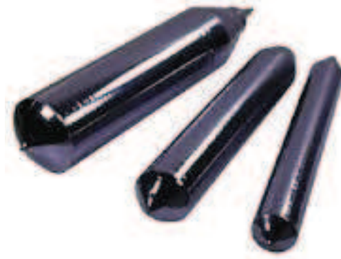
Figura 9 - Cilindros formados por silício (lingotes)
