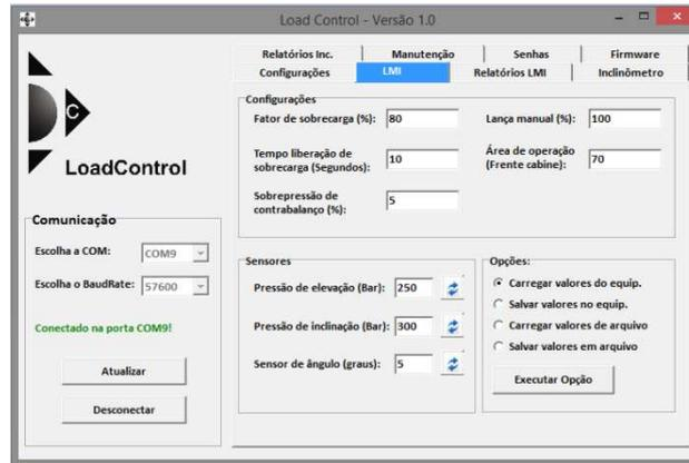
Figura 9 – Software de integração do Limitador de Carga com computador
