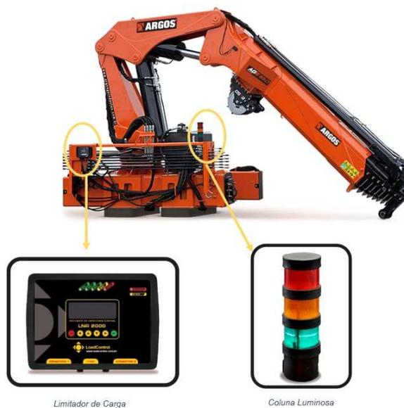
Figura 2 – Central LMI montada em Guindaste articulado com coluna luminosa
