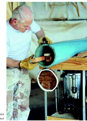
Preparação com água quente FINE WOOD WORKING, Bending Wood, 1985
