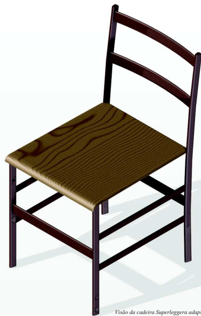
Visão da cadeira Superleggera adaptada ao processo de produção com madeira vergada
