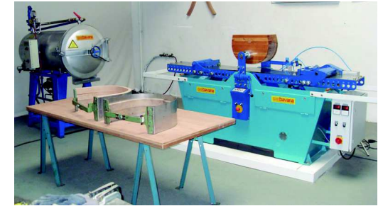
Conjunto autoclave, máquina para vergar e moldes GUEBAVARIA, 2012
