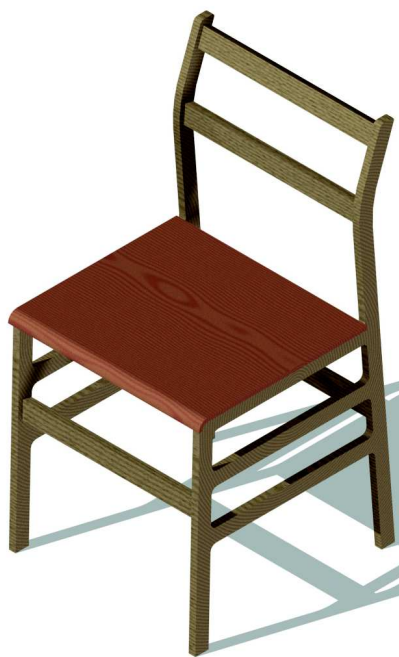
Visão da cadeira Superleggera adaptada ao processo de produção com placas de madeira
