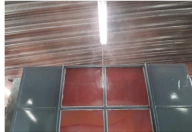
Figura 4.6 Fuga de ar na região frontal da câmara de pressurização.
