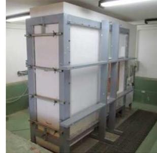
Figura 2.42 Câmara de pressurização II.
