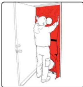
Figura 2.31 Montagem Blower Door Test a.
