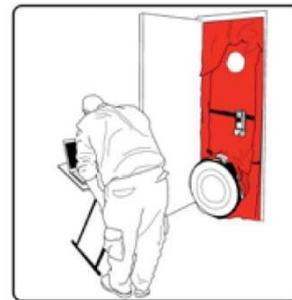
Figura 2.32 Montagem Blower Door Test b.
