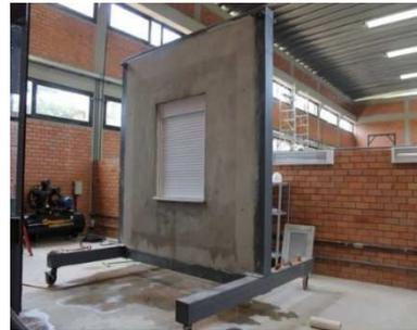
Figura 3.7 Parede de alvenaria sobre pórtico.
