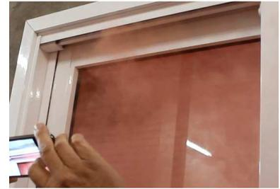
Figura 4.14 Infiltração de ar região superior esquadria de correr III.
