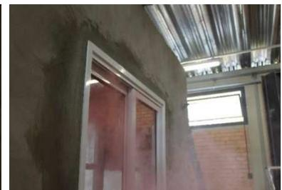
Figura 4.11 Infiltração de ar região superior esquadria de correr I.
