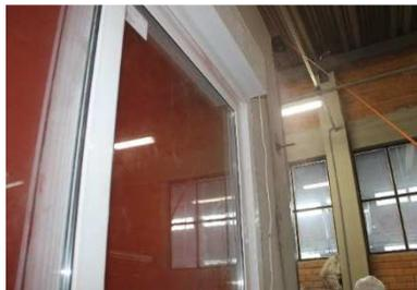
Figura 4.35 Infiltração de ar global esquadria integrada.
