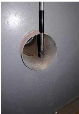
Figura 3.21 Posicionamento do anemômetro de fio quente na câmara de pressão.
