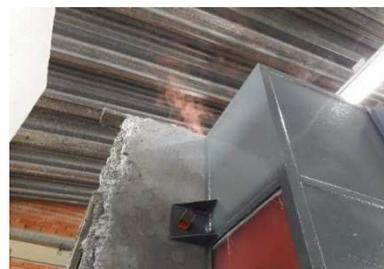
Figura 4.3 Fuga de ar na região superior da câmara de pressurização.
