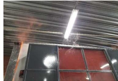
Figura 4.32 Fuga de ar na região frontal da câmara de pressurização.
