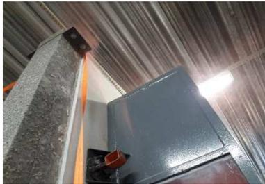
Figura 4.31 Fuga de ar na intersecção das regiões superior e lateral da câmara de pressurização II.
