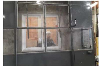
Figura 3.31 Retirada do filme plástico e pressurização da câmara.
