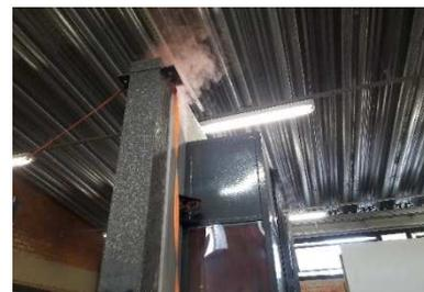
Figura 4.30 Fuga de ar na intersecção das regiões superior e lateral da câmara de pressurização I..
