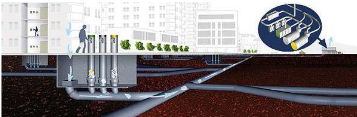
Figura 16 – Estrutura de tubulação pneumática de resíduos. Fonte: http://infraestruturaurbana.pini.com.br/solucoes-tecnicas/11/coleta-de-lixo-subterranea-e-a-vacuo-conheca-modelo-245157-1.aspx - Acesso em 14 de dezembro de 2015.
