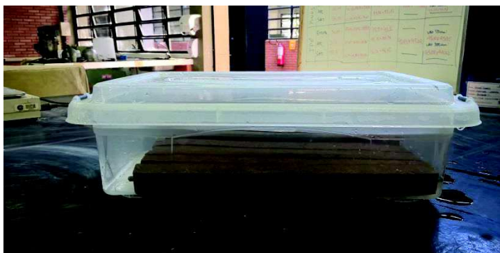
Figura 29 – Barras de argamassas submersa em água, colocadas em estufa à 80°C.
