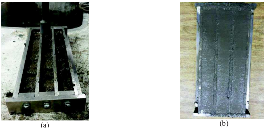
Figura 24 - Moldagem dos corpos de prova para RAA
