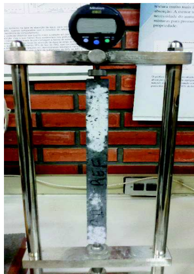
Figura 25 – Leitura da barra com base no relógio comparador.
