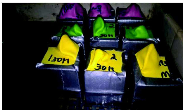
Figura 27 – Ensaio de absorção de água por capilaridade.
