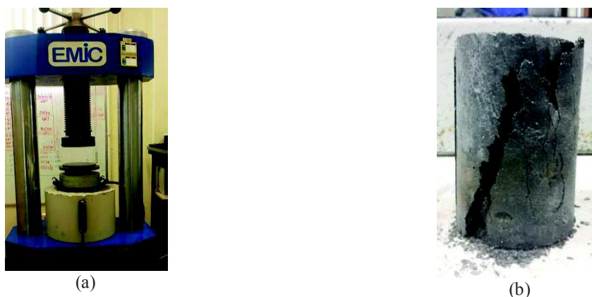
Figura 26 - Prensa e corpo de prova após o ensaio.
