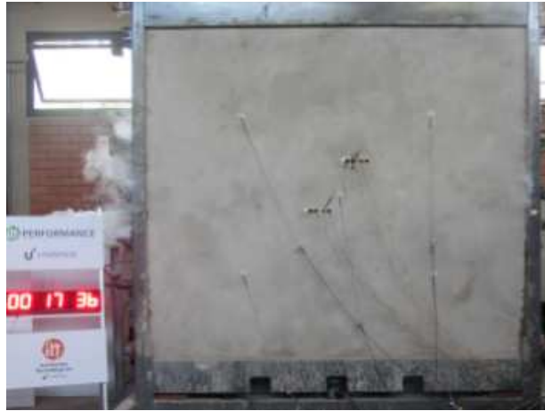
Figura 59 - Fumaça expelida pela fissura vertical e seu entorno
