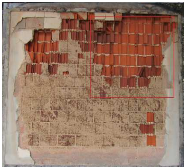
Figura 65 - Amostra P4 após ensaio de resistência ao fogo
