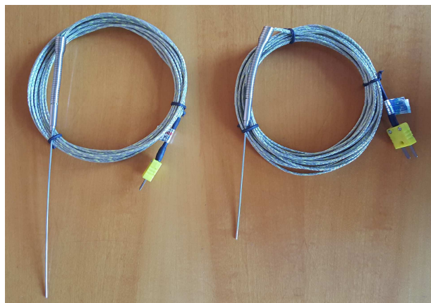
Figura 28 – Termopares Ø1,5 mm
