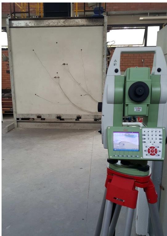
Figura 30 - Leituras na amostra com estação total
