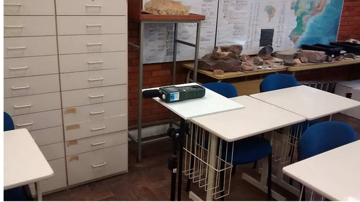
Figura 3.9 - Medição do nível de pressão sonora na sala C08108
