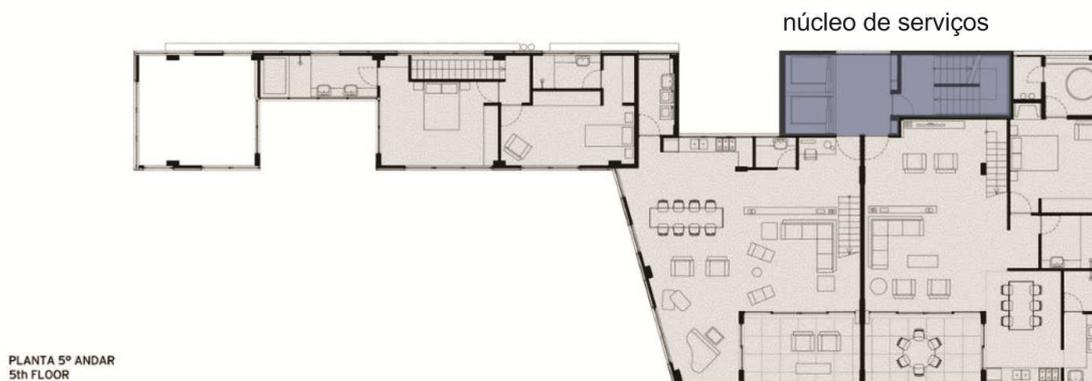
Figura 158 - Edifício Fidalga 772. Planta baixa com a localização do núcleo de serviços. Adaptado de: <http://www.arquiteturaguimattos.com.br> Acesso: 08 nov. 2016.
