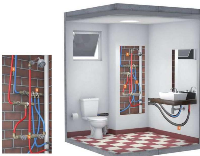
Figura 112 – Shaft que utiliza instalações do tipo PEX. Disponível em: <http://equipedeobra.pini.com.br> Acesso: 17 fev. 2016.
