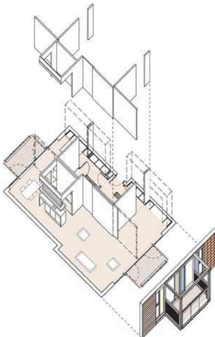
Figura 89 – Esquema de utilização de divisórias leves no Greenwich Millennium Village, projetado por Proctor and Matthews Architects, Londres, Inglaterra. Disponível em: <http://www.afewthoughts.co.uk> Acesso: 02 mar. 2016.
