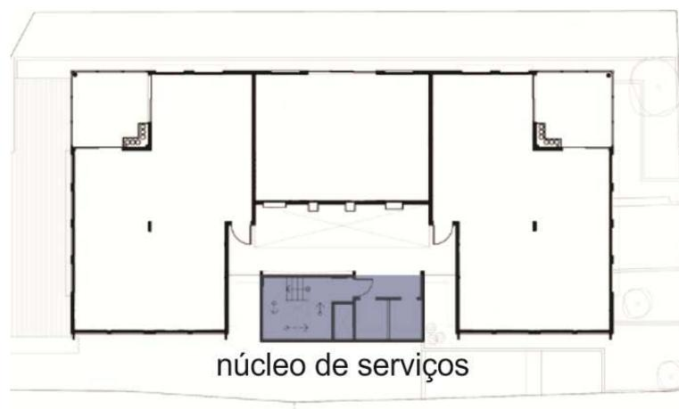
Figura 137 - Edifício 4x4. Planta baixa com a localização do núcleo de serviços. Adaptado de: <http://www.arquiteturaguimattos.com.br> Acesso: 08 nov. 2016.
