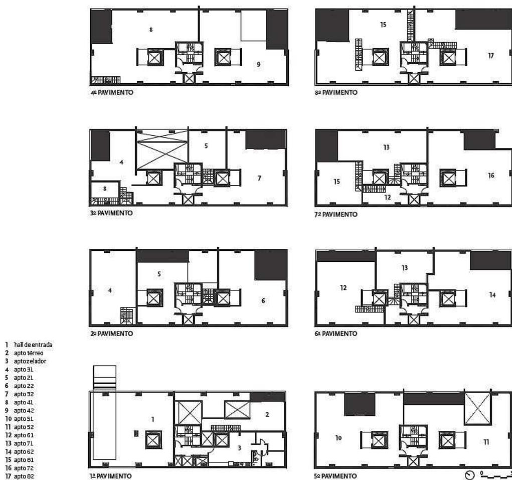
Figura 34 – Edifício Ourânia. Plantas baixas dos pavimentos tipos. Disponível em: <http://www.au.pini.com.br> Acesso: 16 jul. 2015.
