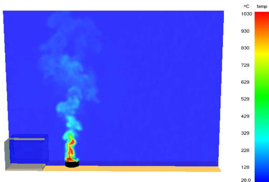
Figura 4.3 – Visualização dos perfis de temperatura da chama e da pluma pelo Smokeview
