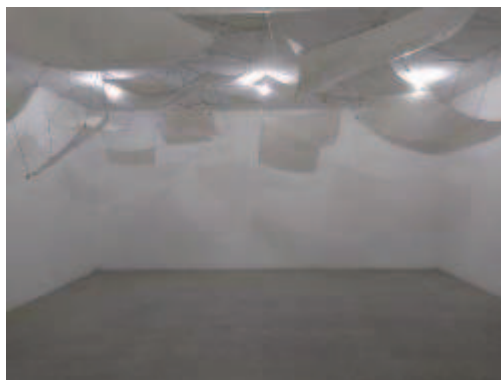
Figura 49 – Foto da câmara reverberante do itt performance da Unisinos
