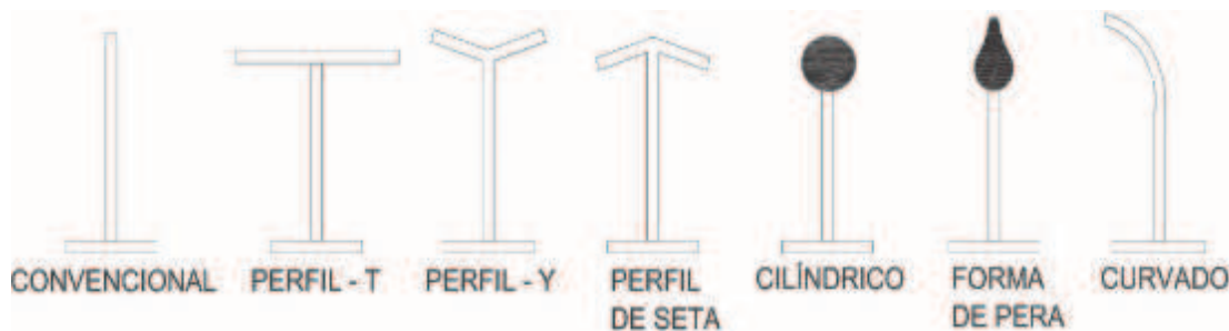
Figura 13 – Possibilidades de acabamento de topo nas barreiras sonoras
