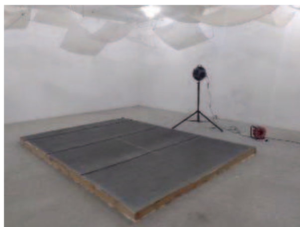
Figura 51 – Posicionamento da fonte sonora no interior da câmara reverberante
