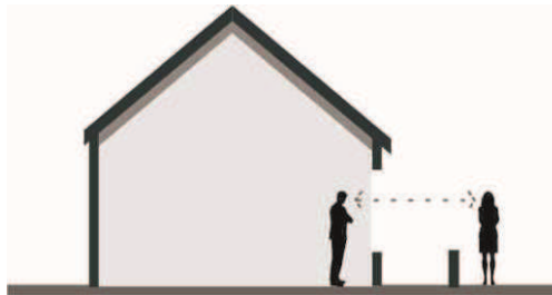
Figura 19 - Permeabilidade na fachada do andar térreo
