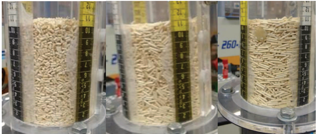
Figura 4.6 - Expansão do leito após fluidização das partículas de 4x2mm, 8x2mm e 12x2mm (leito solto)
