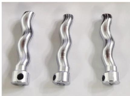
Figura 3.2 – Rotores em aço SAE 12L14 revestido de cromo, originais da BCP da Percolore
