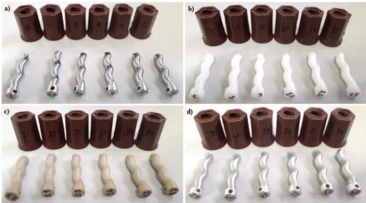
a) Rotores de aço SAE 12L14 cromados; b) Rotores de PA6; c) Rotores de PEEK; d) Rotores de alumínio Liga 6082
