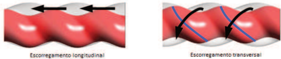
Figura 2.16 – Representação dos mecanismos de escorregamento de uma BCP
