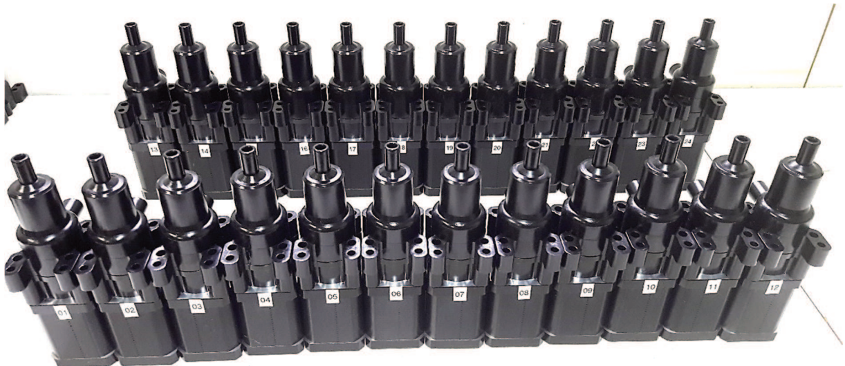
Figura 4.5 – Bombas montadas com os respectivos corpos de prova
