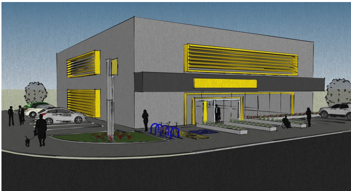
Figura 32 - Edifício referência, aberturas sombreadas por meio de brises.
