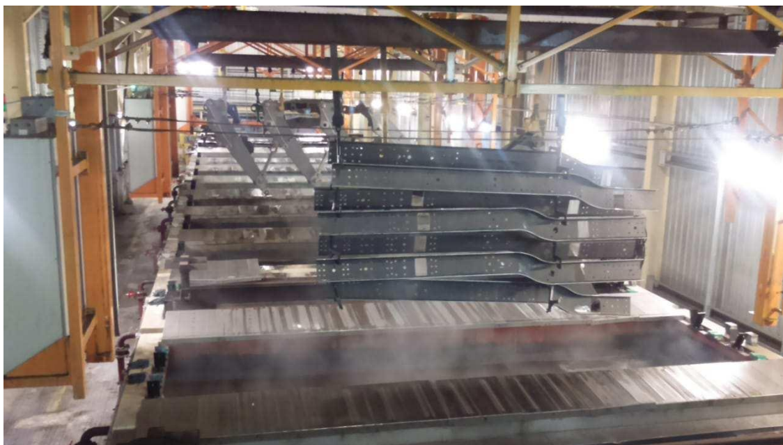
Figura 24 – Sistema de pintura E-coat
