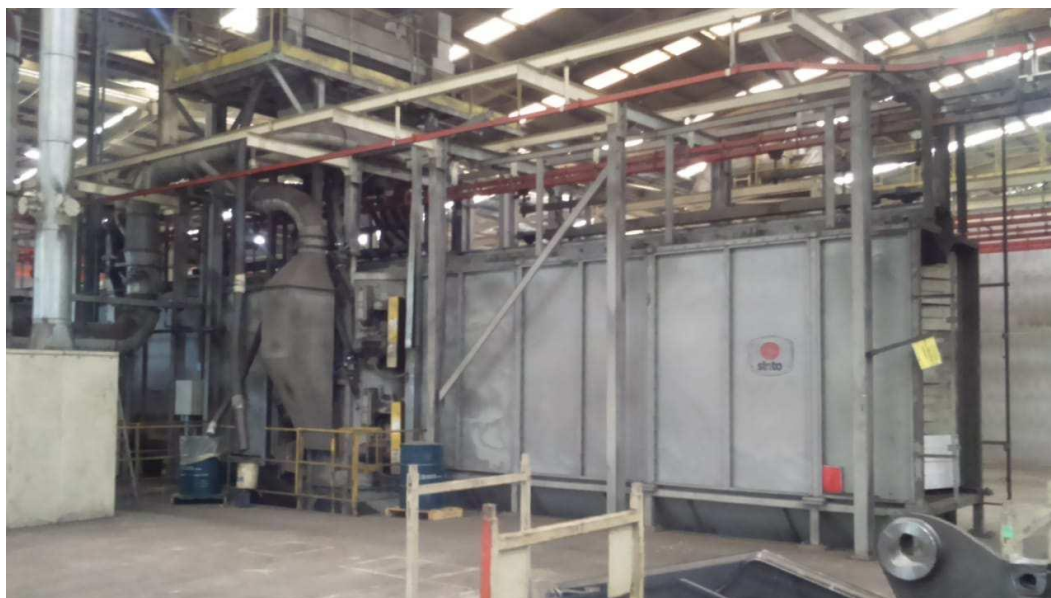
Figura 23 – Imagem do Jato de Granalha
