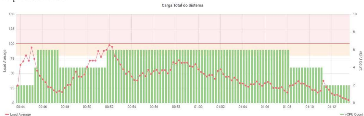
Na Figura 18 vemos que máquinas são instanciadas e desalocadas mais vezes em comparação a Figura 19. Essas decisões foram tomadas baseando-se no resultado do algoritmo de predição do ARIMA, e buscam deixar a alocação de máquinas o mais próxima possível da
