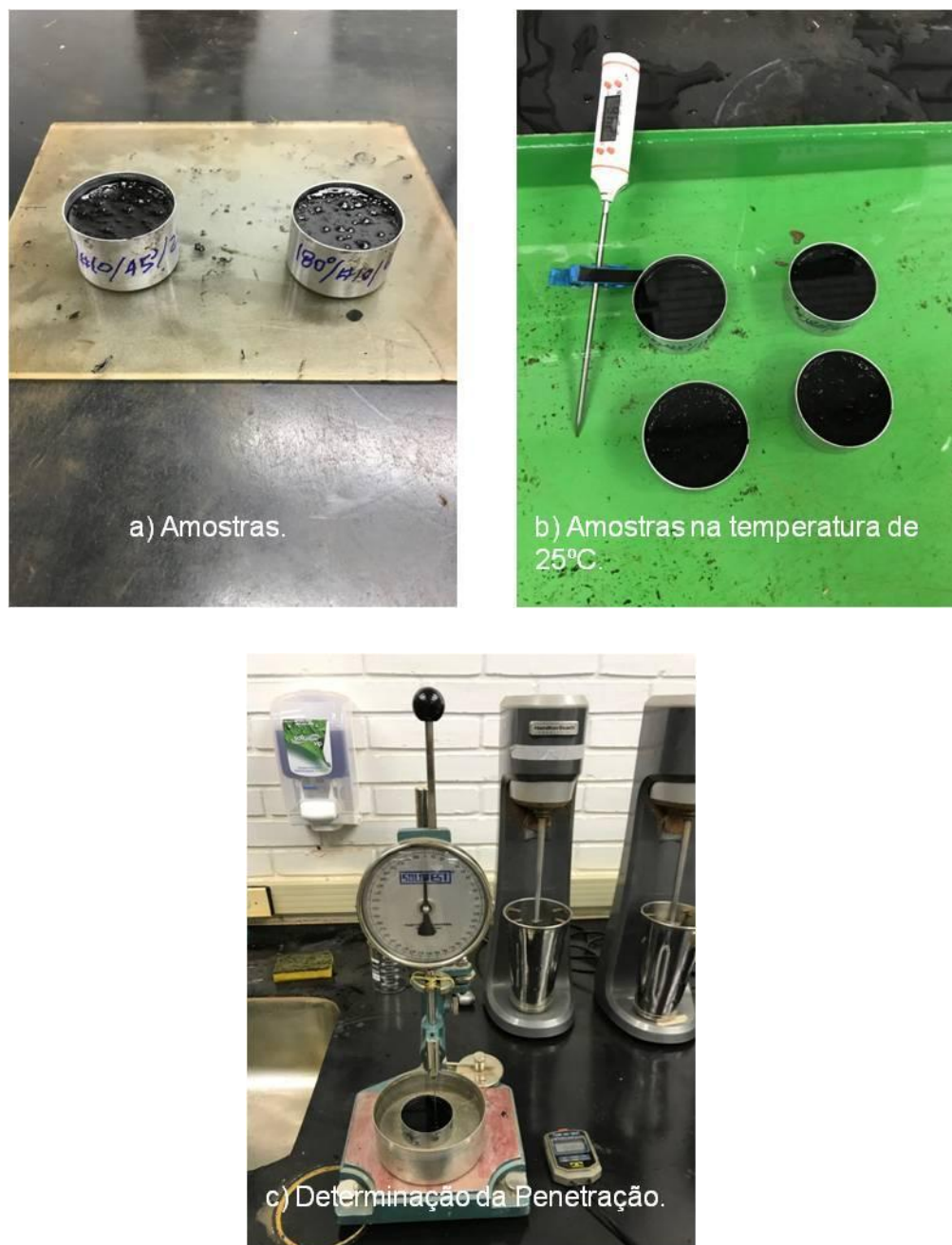
Figura 12 – Determinação da Penetração. Fonte: Autor
