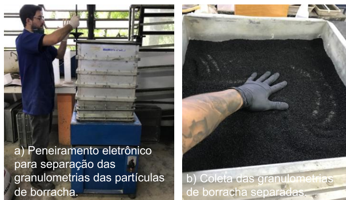
Figura 10 – Processo de separação das granulometrias da borracha. Fonte: Autor
