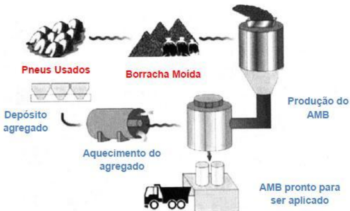
Figura 3 – Esquema de fabricação do Asfalto-Borracha pela via úmida pelo sistema não estocável ( Continuous Blending ) (CALTRANS, 2005).
