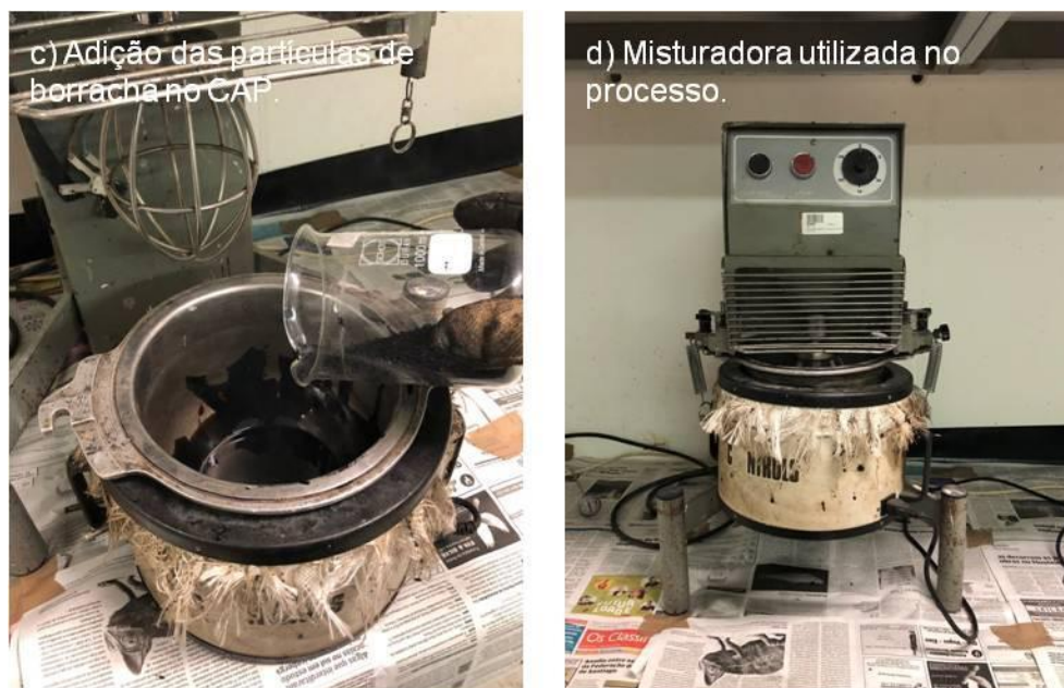
Figura 11 – Processo produção do Asfalto-Borracha. Fonte: Autor
