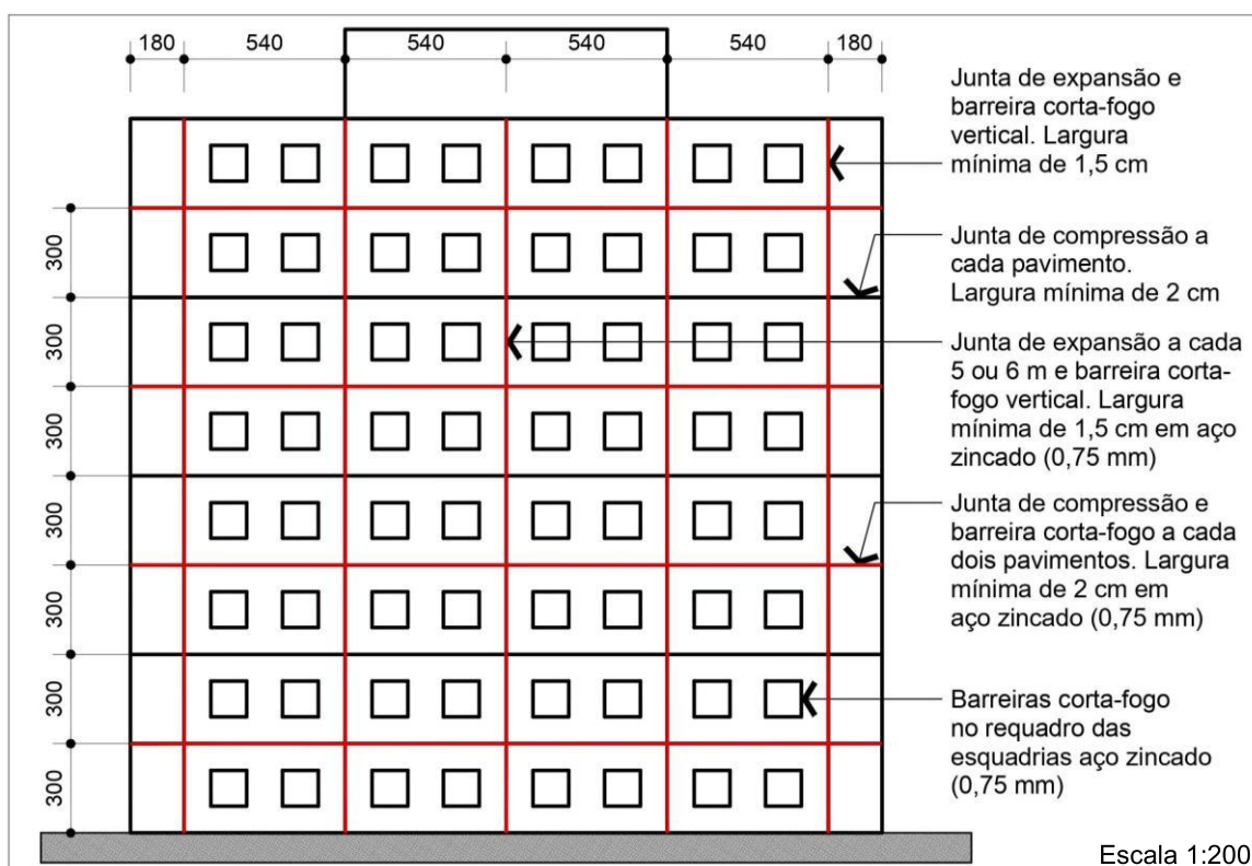
Figura 29 - Elevação 4 (barreiras corta-fogo)
