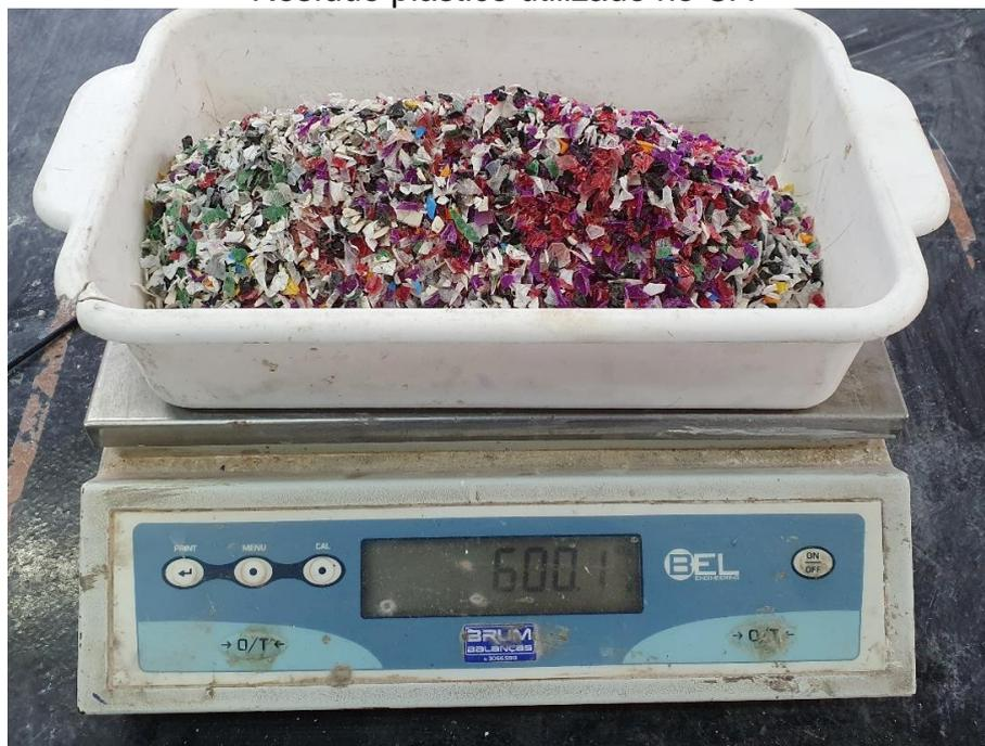
Ensaio de densidade do agregado miúdo
