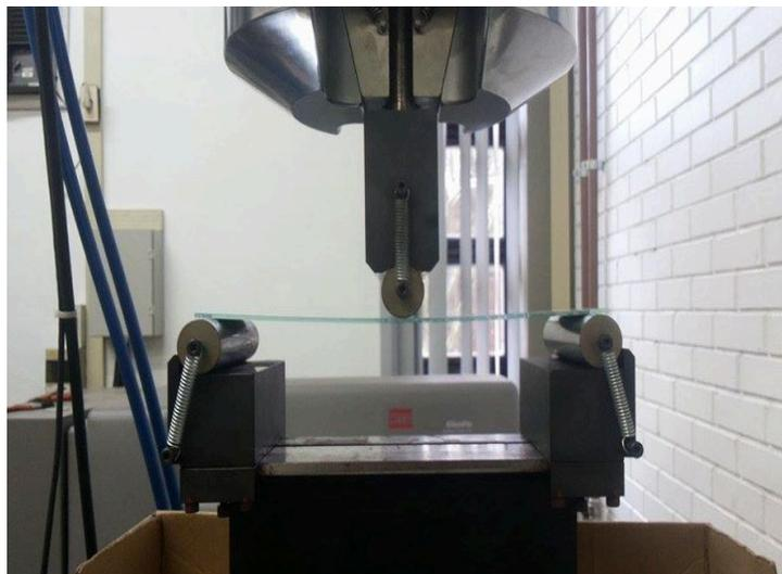
A Figura 28 mostra os resultados obtidos para espelhos de 3 e 4 mm de espessura, respectivamente. Estes testes comprovaram que a utilização de espelhos de 3 mm de espessura é adequada, pois permite uma maior curvatura com menor esforço e custo.
