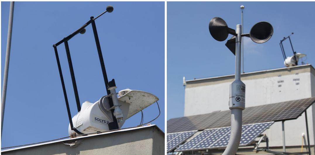
O anemômetro está instalado conforme mostrado na Figura 42, de maneira a não sofrer interferências ou bloqueios ambientais.
