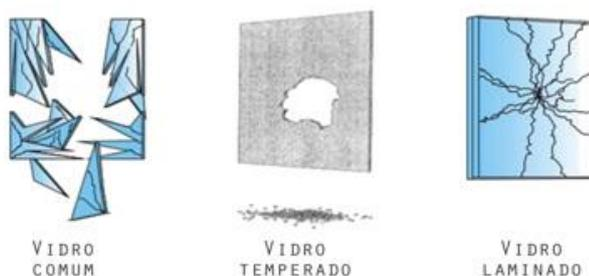
Ainda é possível a criação de um vidro laminado-temperado, que alia a maior resistência mecânica do vidro temperado com a integridade do vidro laminado. Este tipo de vidro é indicado para vãos maiores, juntas secas ou fixação por ferragens (MARTINS, 2018).
