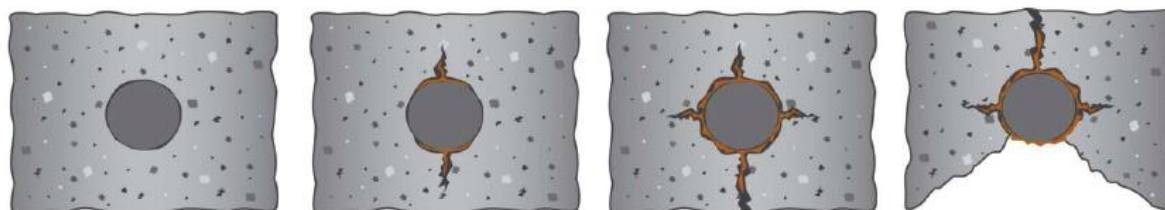
Figura 5 – Avanço do mecanismo de corrosão nas estruturas de concreto armado
