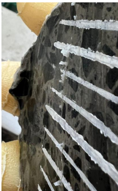
Figura 61 – Formação de produto de autocicatrização de coloração branca e em forma de estalactite
