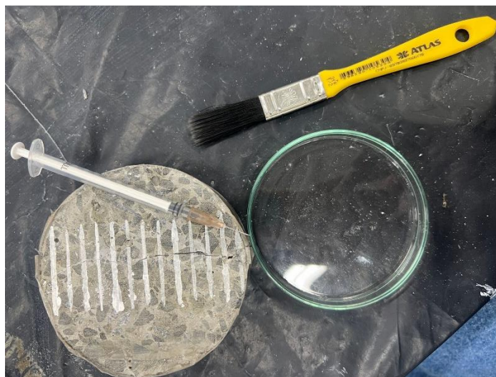
Figura 48 – Procedimento de retirada dos produtos de cicatrização para análise de DRX
