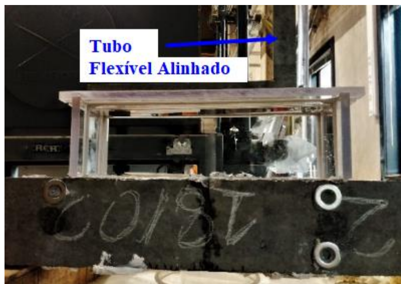
Figura 12 – Metodologia adotada por Tsangouri et al. (2022) para a determinação do coeficiente de permeabilidade de água
