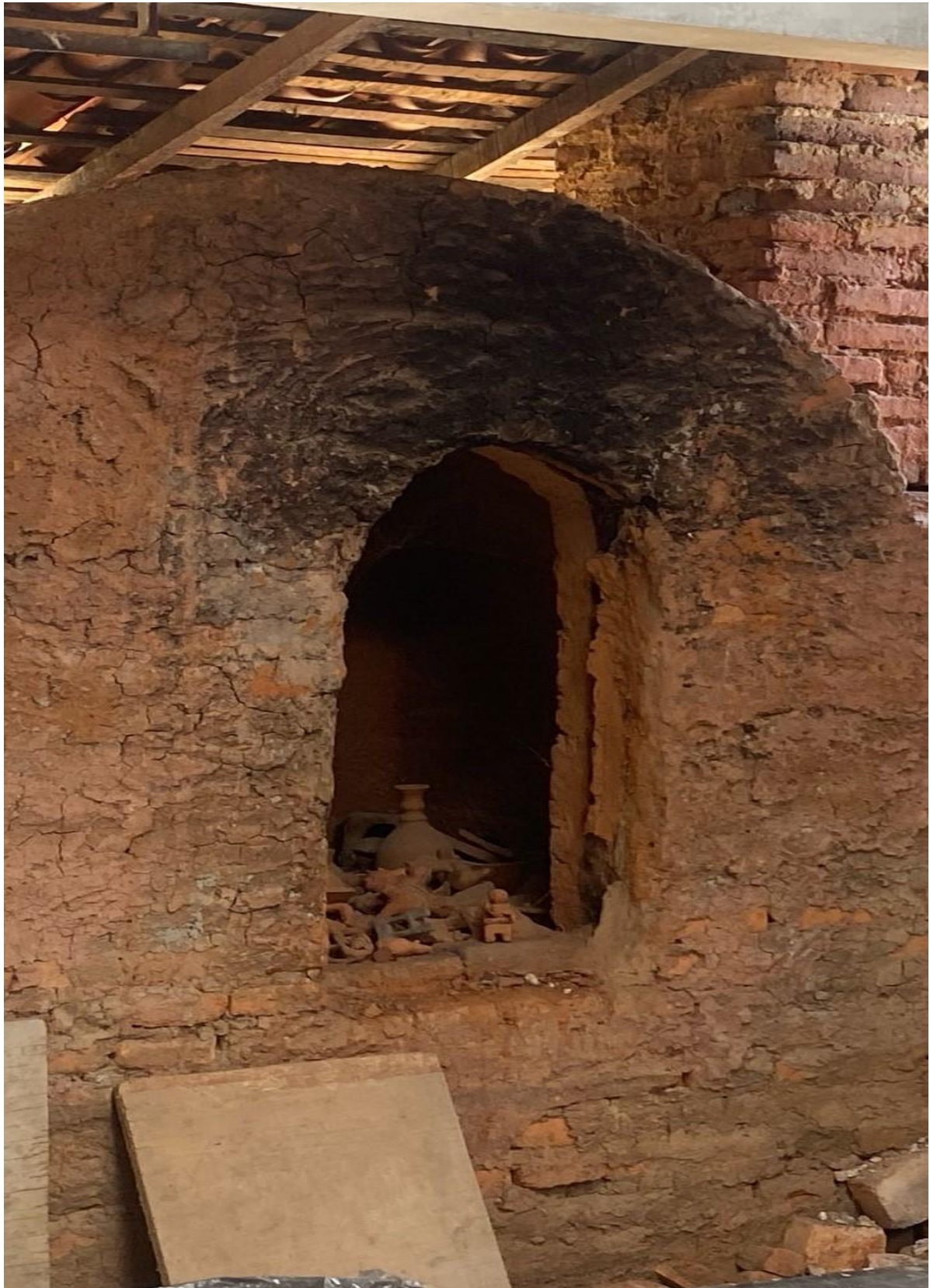
Fotografia 5 – Forno para queima de peças de barro. Polo Cerâmico Artesanal do Poti Velho. Zona Norte de Teresina - PI.
