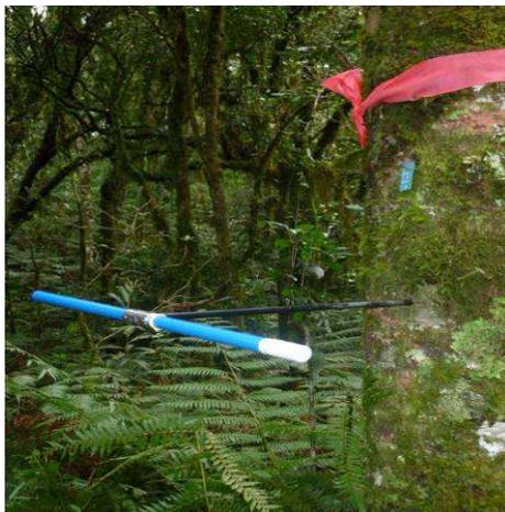
Apêndice 1: Inserção perpendicular do trado de incremento ao eixo da árvore.
