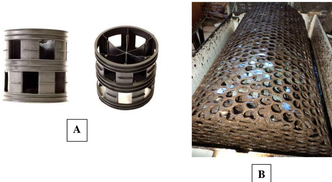
**Figura 4: Material suporte utilizado como recheio no CBR (A) e tambor do CBR (B).**
