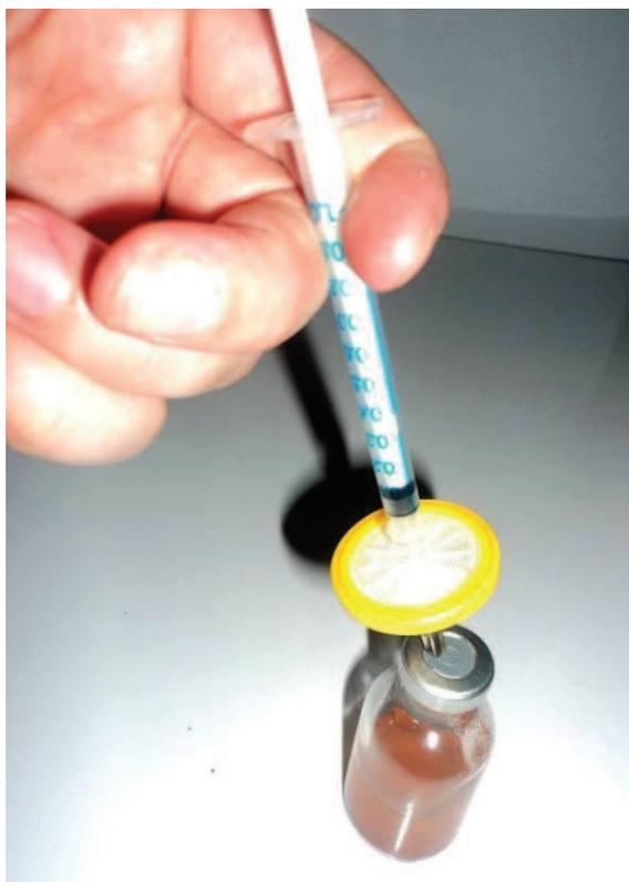
Figura 16. Introdução de gás com o auxílio de Acrodisc - marca Millipore®, no frasco.
