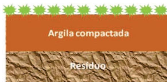
Figura 11 – Modelo de camada de cobertura evapotranspirativo monolítico.
