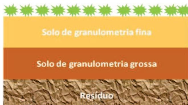
Figura 12. Modelo de camada de cobertura evapotranspirativo capilar simples.
