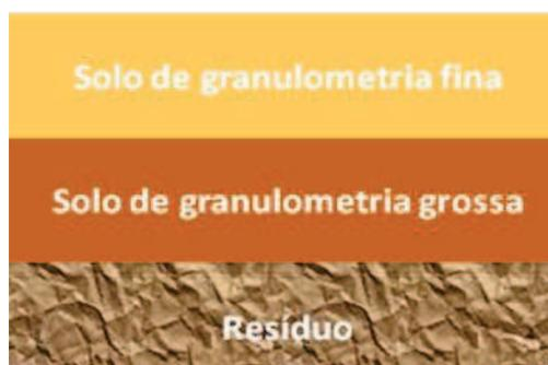
Figura 9. Esquema do sistema de uma barreira capilar simples.
