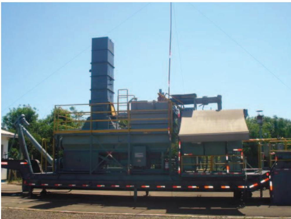
Figura 19. Evaporador de lixiviado do aterro municipal de São Leopoldo (imagem captada em 06/2009).
