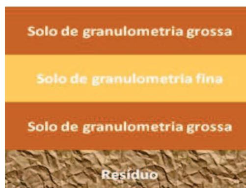
Figura 10. Esquema do sistema de uma barreira capilar dupla.
