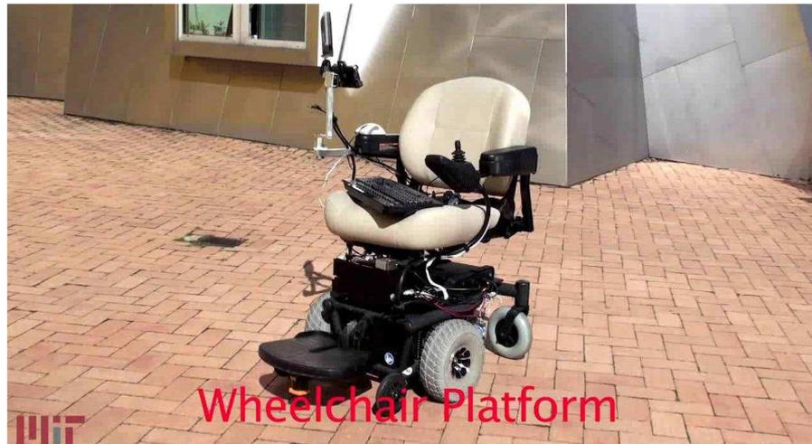
Tem seu funcionamento centrado em ambientes *indoor*, para isso utiliza um dispositivo *wireless* para determinação da localização (*WiFi based localization*). Além disso, possui um *software* para controle do motor da cadeira de rodas.
