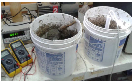
Figura 17 – Realização do ensaio: medição da resistividade elétrica no estado fresco.
