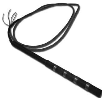
Figura 10 - Sonda de resistividade elétrica para medida da relação água/cimento de concretos no estado fresco
