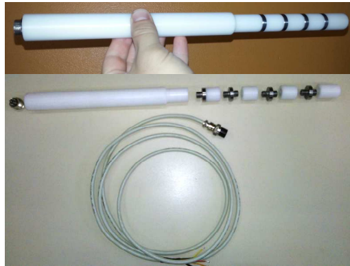
Figura 16 – Sonda produzida para os ensaios de resistividade elétrica
