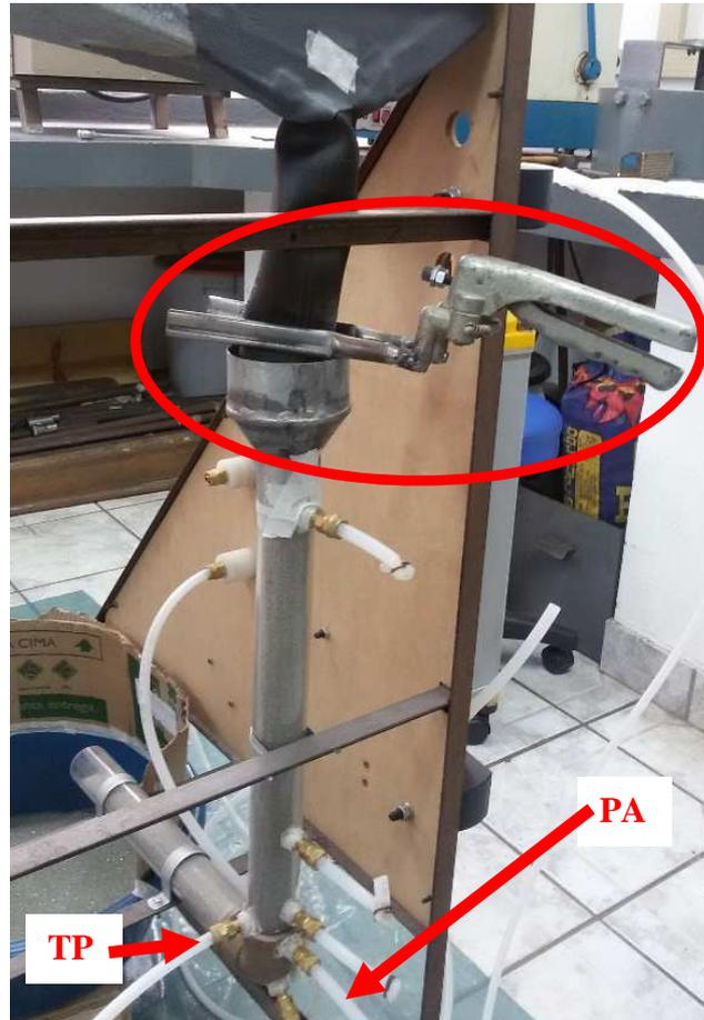
Figura 3.2 – Grampo de metal para o controle de partículas na entrada da válvula L de 34 mm. Sendo: TP tomada de pressão e PA ponto de aeração.
