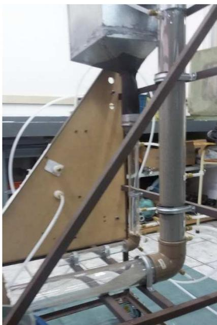
Figura 3.4 – *Downcomer* da válvula L sendo enchida com partículas de 1,216 mm.
