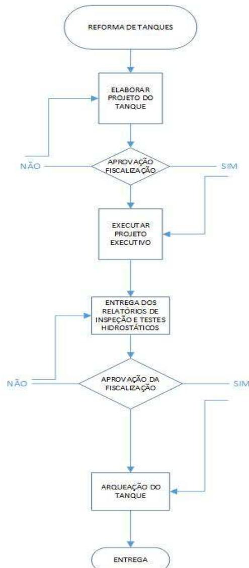
Figura 5 – Fluxograma de processos da reforma dos tanques desenvolvido pelo autor.
