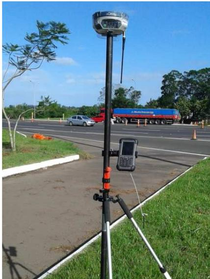
Figura 10: Receptor marca SOKKIA, Modelo GRX2 e Coletora GETAC.
