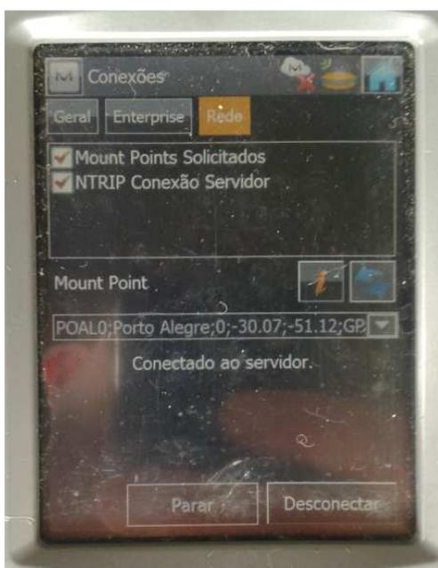
Figura 11: Coletora GETAC conectada ao servidor Caster, recebendo correções da Base POAL.
