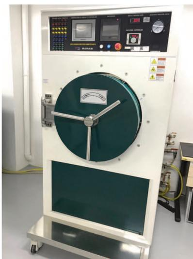
**Figura 3-14** – Câmara térmica utilizada para expor os corpos de amostra Pa temperatura e umidade pré-definidas.
