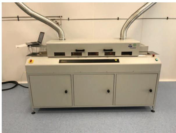
**Figura 3-10 – Forno de refusão DDM Novastar.**
