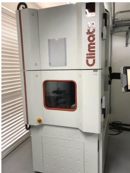
**Figura 3-11 – Câmara de choque térmico Climats Spirale 3.**
