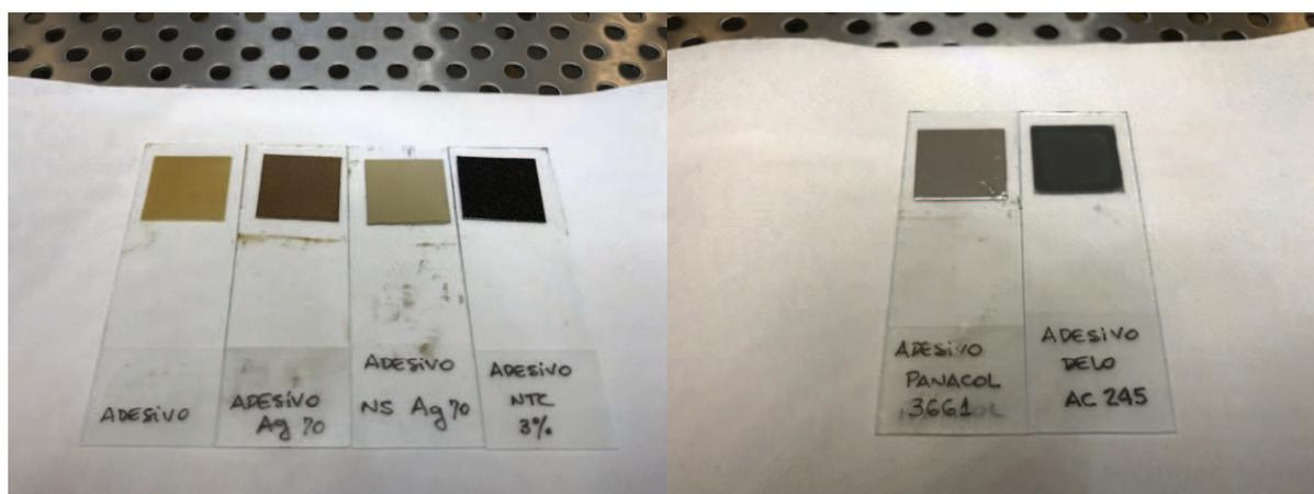
**Figura 3-5** – Corpos de prova para medição no perfilômetro e 4 pontas.
