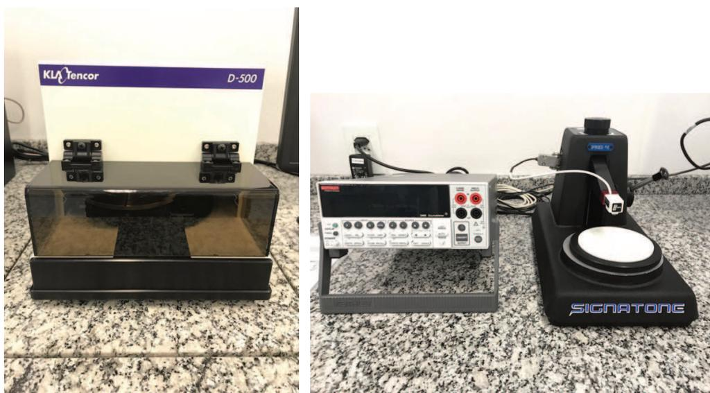
**Figura 3-6** – Equipamentos utilizados – perfilômetro (esquerda) e 4 pontas (direita).
