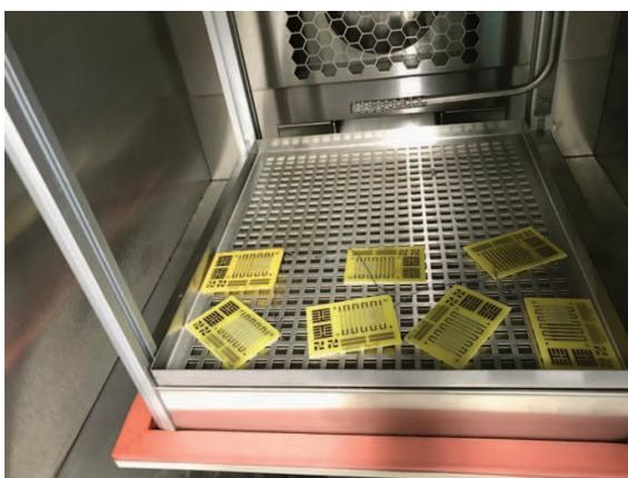
**Figura 3-12 – Corpos de prova acomodados sobre a bandeja da câmara.**
