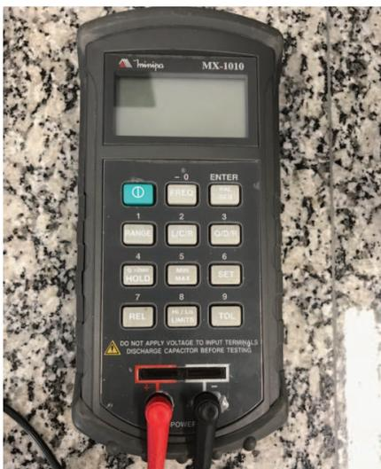
**Figura 3-13** – Ponte LCR utilizada nas medições das conexões e juntas tanto de solda quanto com adesivos.
