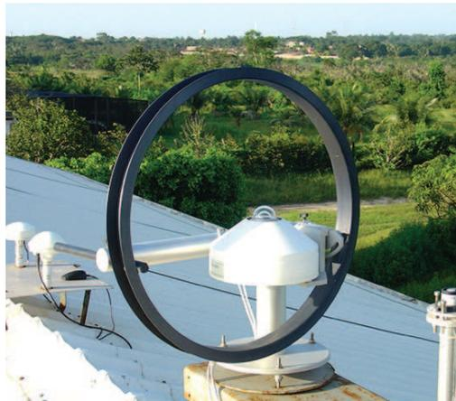
Figura 2.5 – Piranômetro com anel de sombreamento.
