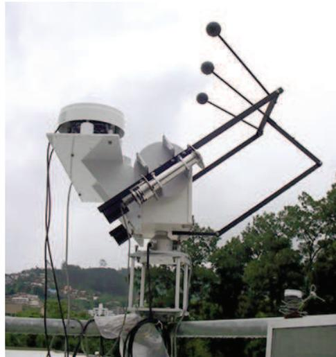
Figura 2.7 – Piranômetro com esfera de sombreamento.
