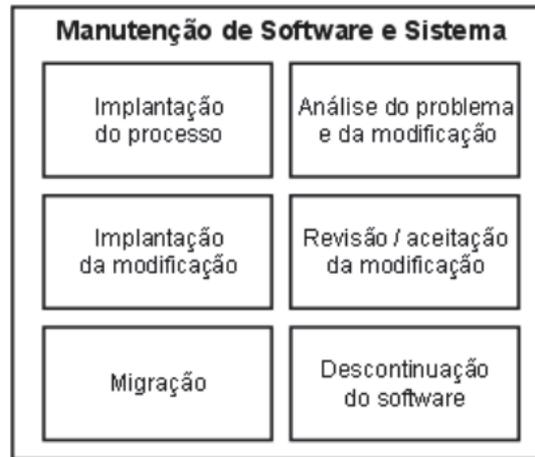
**Figura 1. Atividades do processo de manutenção de software e sistema.**
