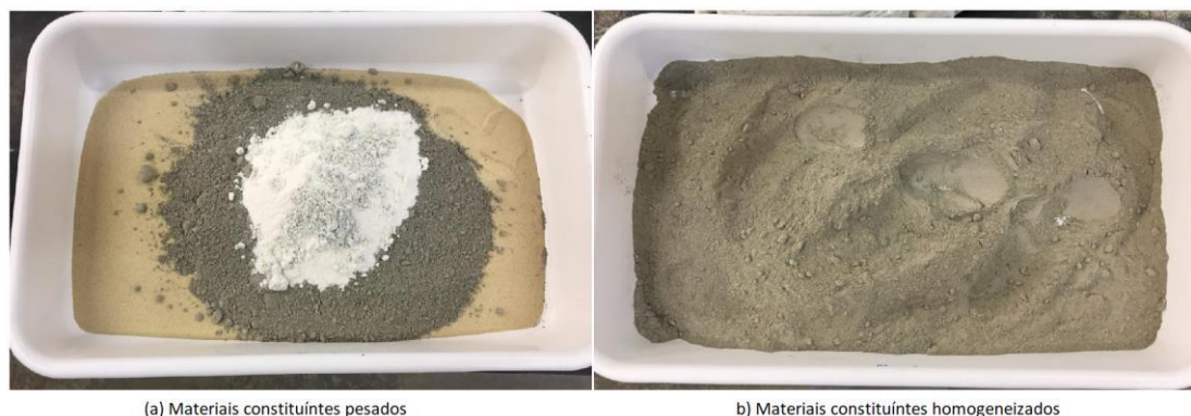
Figura 33 – Materiais constituintes da argamassa colante
