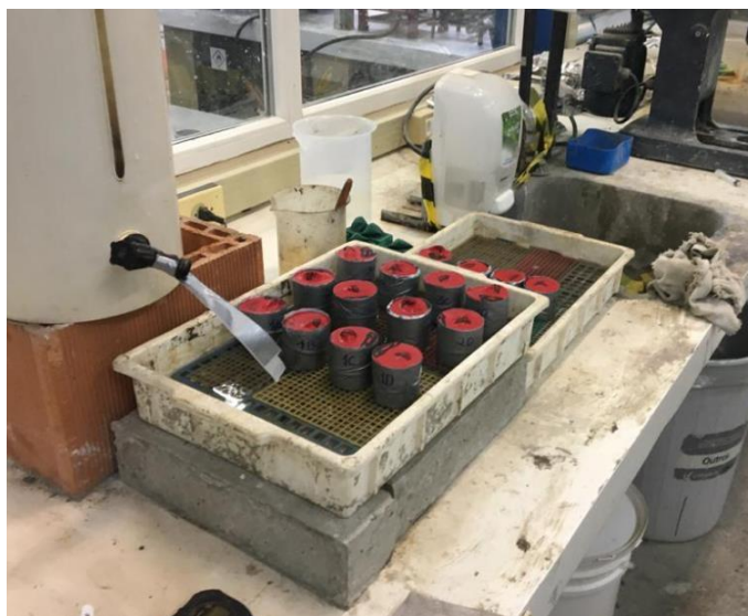
Figura 40 – Ensaio de absorção de água por capilaridade em andamento
