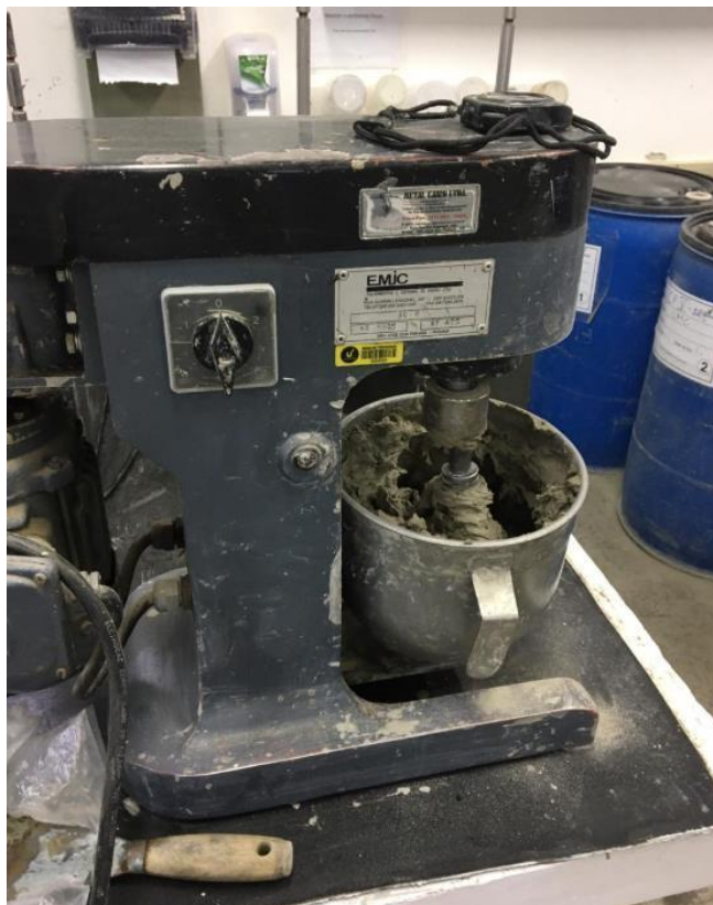
Figura 34 – Argamassadeira utilizada para a confecção da argamassa colante
