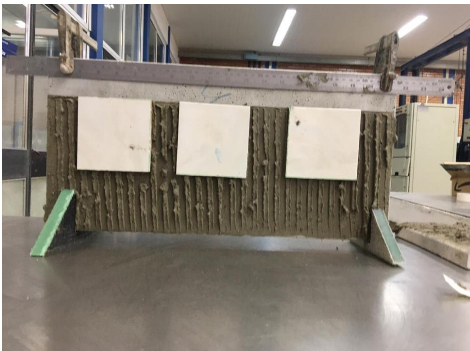
Figura 35 – Ensaio de deslizamento em andamento
