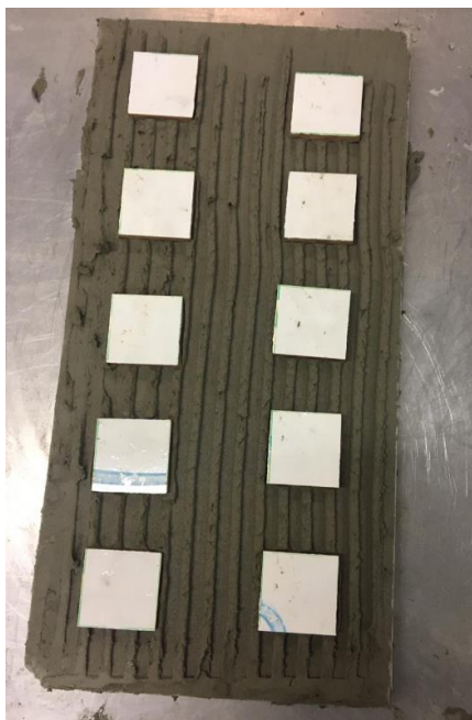
Figura 37 - Placas cerâmicas assentadas na argamassa colante
