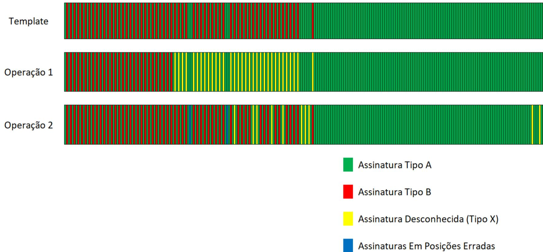
Figura 45: Comparativo das Posições das Assinaturas de Vibração em Suas Respectivas Operações.
