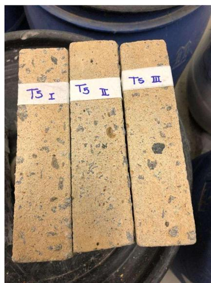
(d) Corpos de prova submetidos a 5 ciclos de ataque de ácido acético
