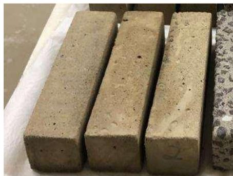
(f) Seção dos corpos de prova submetidos a 5 ciclos de ataque de ácido acético
