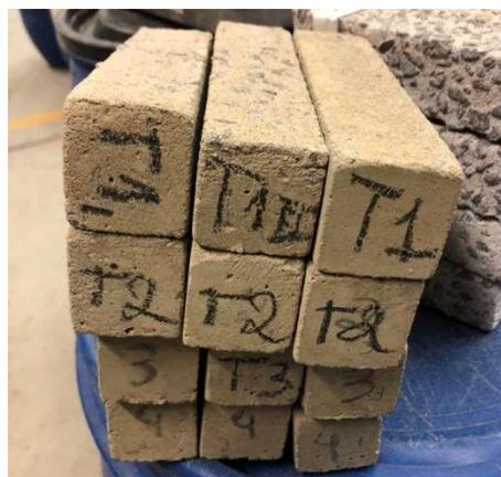
(b) Corpos de prova após 5 ciclos de ataque de ácido acético
