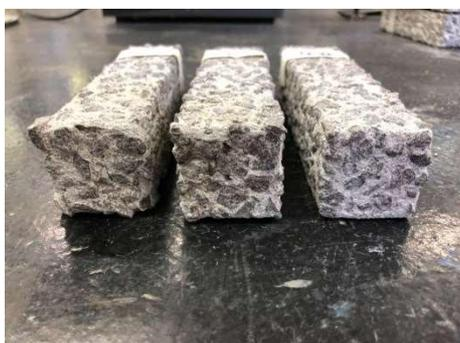
(e) Seção dos corpos de prova submetidos a 5 ciclos de ataque de ácido sulfúrico
