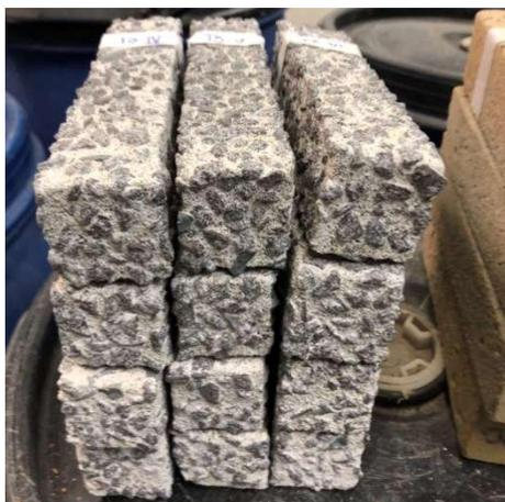
(a) Corpos de prova após 5 ciclos de ataque de ácido sulfúrico
