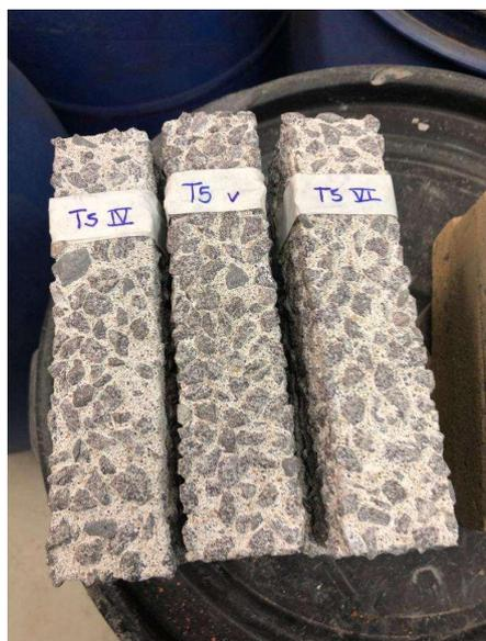
(c) Corpos de prova submetidos a 5 ciclos de ataque de ácido sulfúrico
